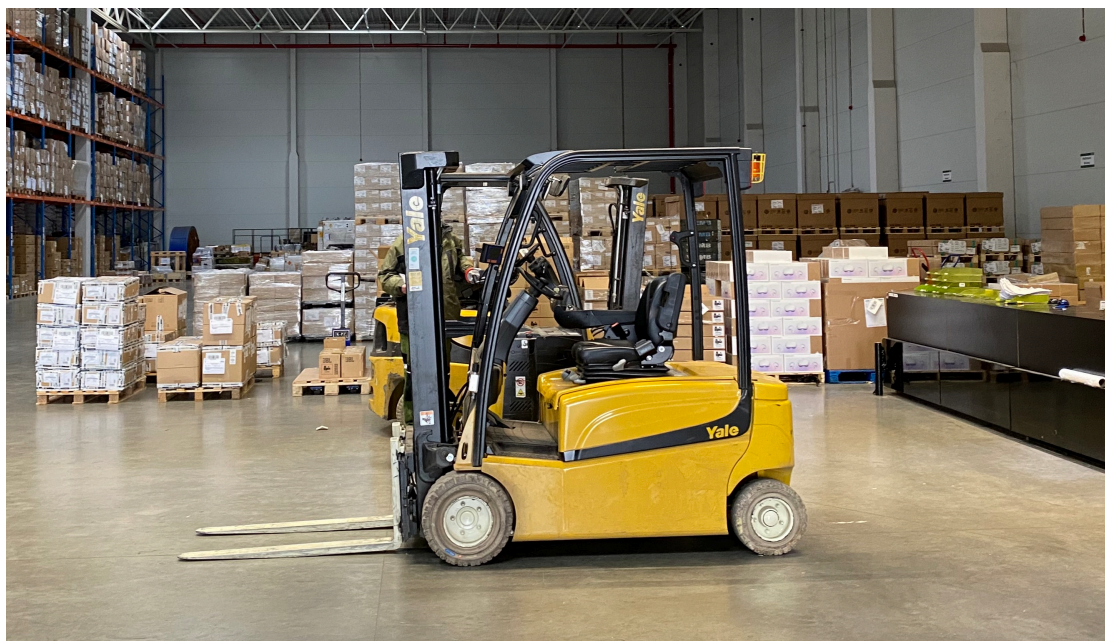
Obrázek 11 Čelní vysokozdvížný paletový vozík Yale
