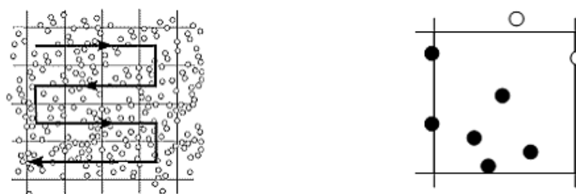
Obrázek 14 - Vlevo znázorněný postup vybírání čtverců, vpravo výběr jednoho z čtverců a ukázka počítání buněk (černé buňky se počítají, bílé ne) [92].
