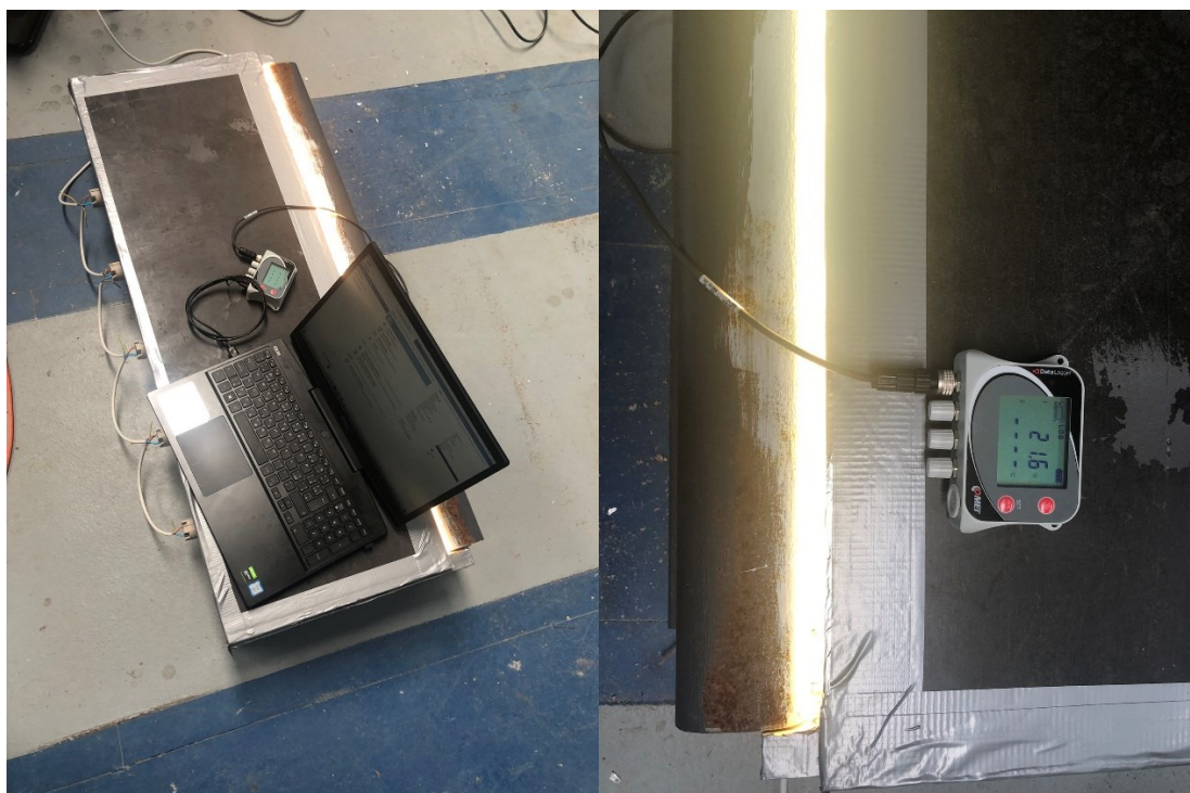
Obrázek 28: Záznam měření kolejnicovým reflektorem
