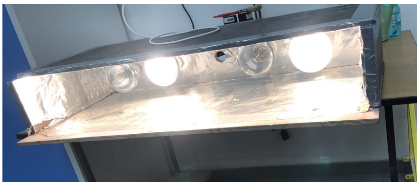
Obrázek 29: Automatizované spínání dvojice žárovek skrze časové relé
