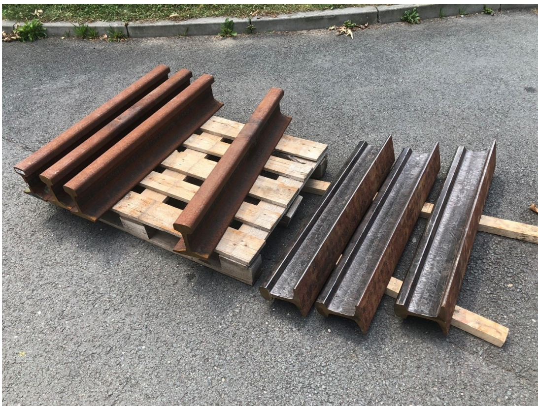
Obrázek 10: Příprava kolejnicových vzorků na nanesení povrchové úpravy
