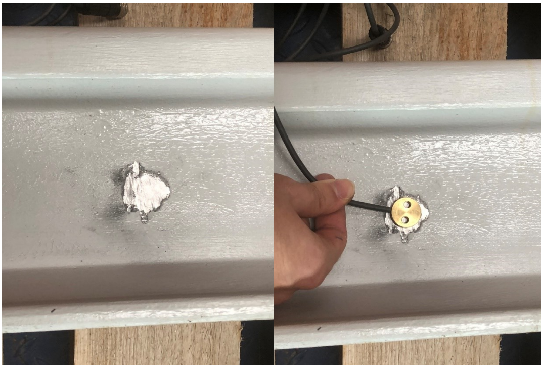
Obrázek 26: Úprava kolejnicových vzorků pro instalaci povrchové teplotní sondy
