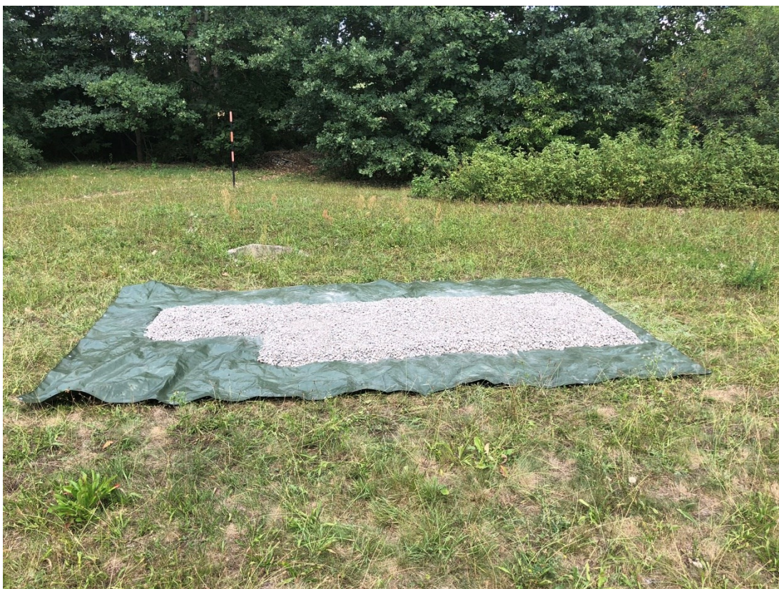
Obrázek 16: Tvarování šterku na měřicím místě
