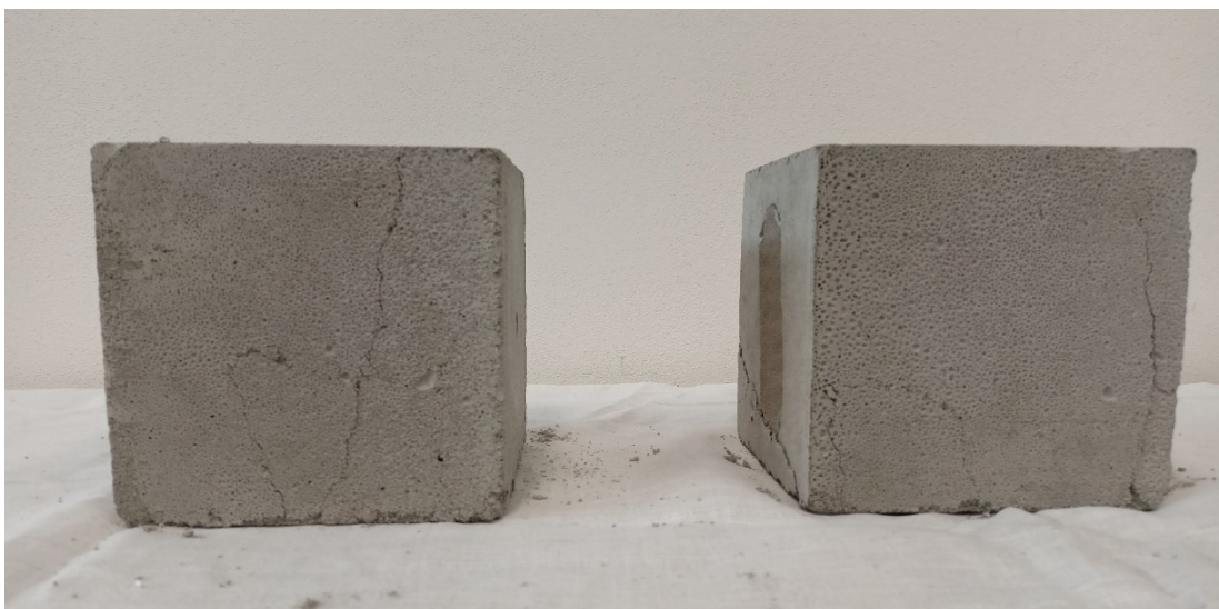
Obr. 22: Porušené krychle po pevnostní zkoušce, RF500
