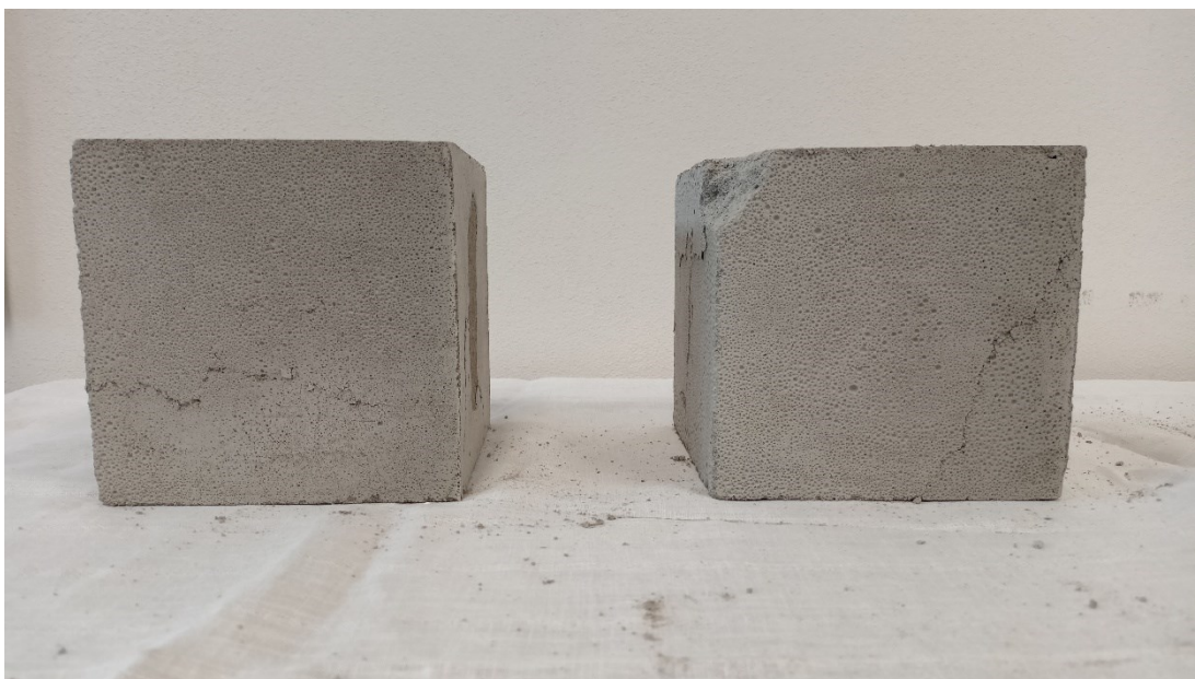
Obr. 29: Porušené krychle po pevnostní zkoušce, CF500+plast
