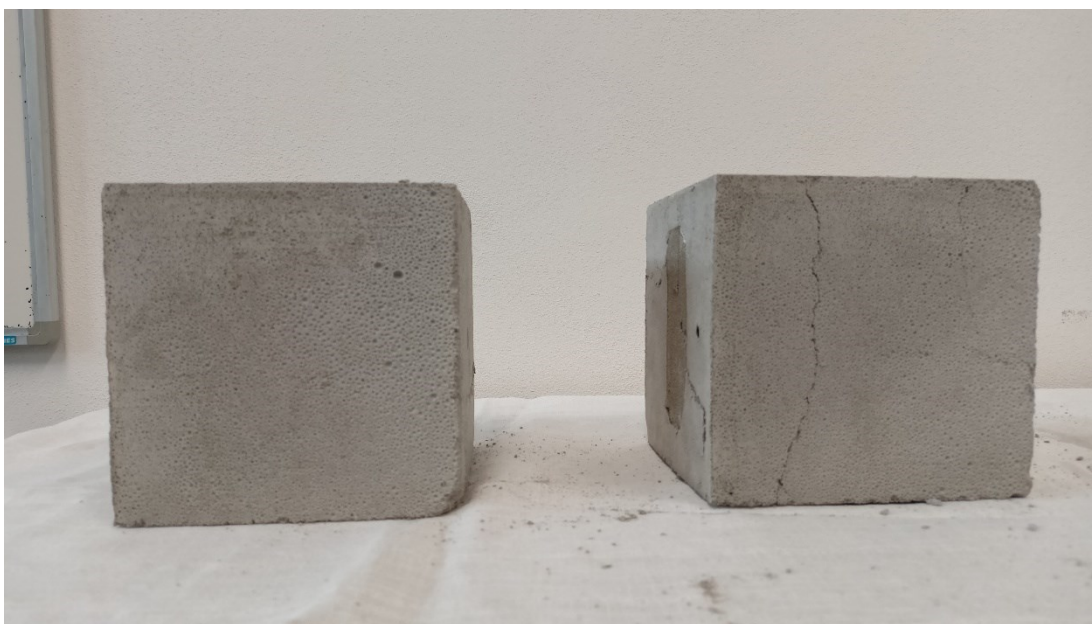
Obr. 32: Porušené krychle po pevnostní zkoušce, CF500+plast
