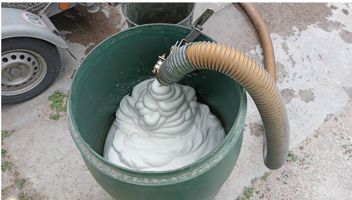
Obr. 10: Pěna vyrobena pomocí pěnogenerátoru
