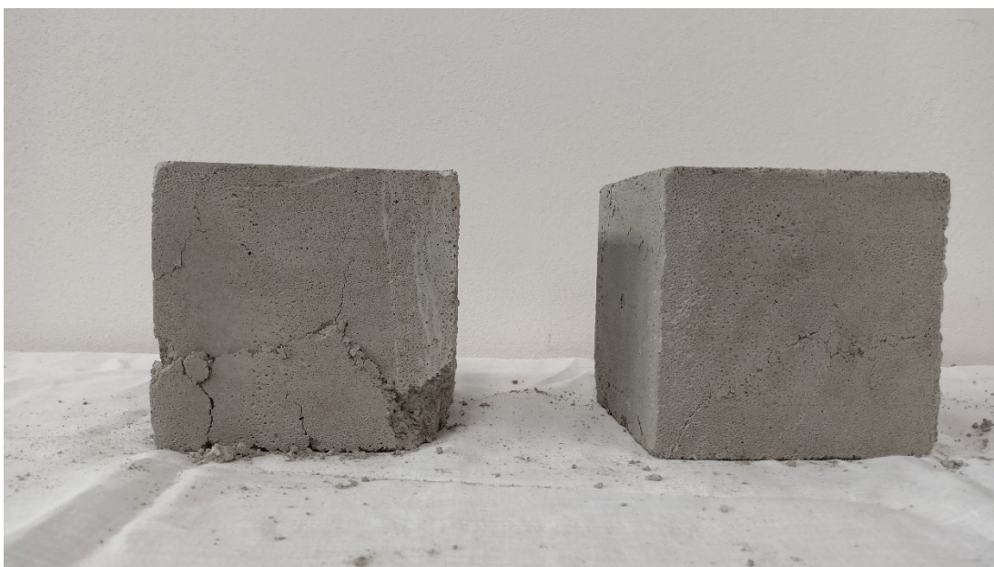
Obr. 26: Porušené krychle po pevnostní zkoušce, RF900
