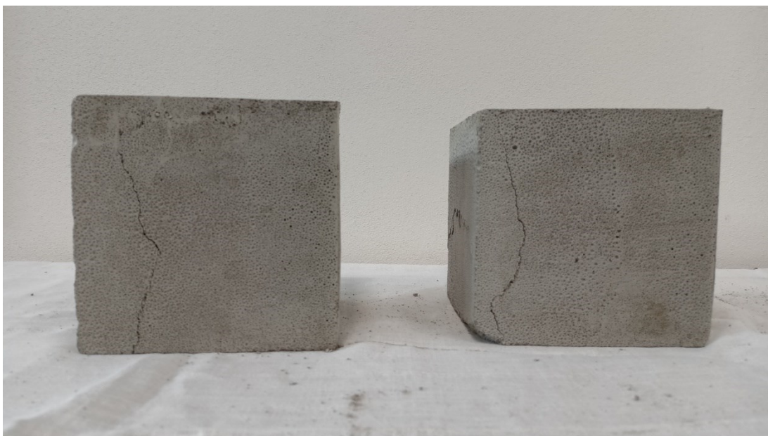
Obr. 20: Porušené krychle po pevnostní zkoušce, CF500
