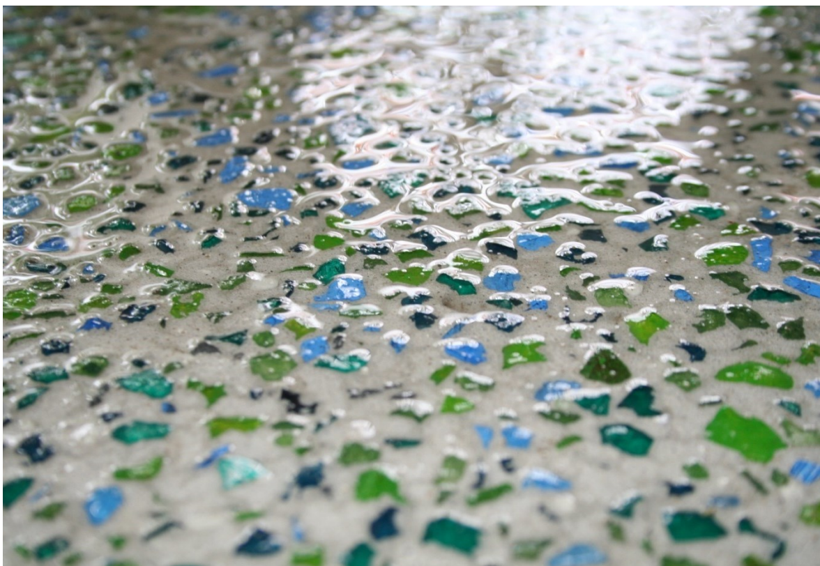
Obr. 3: Recyklované drcené sklo v betonu [21]
