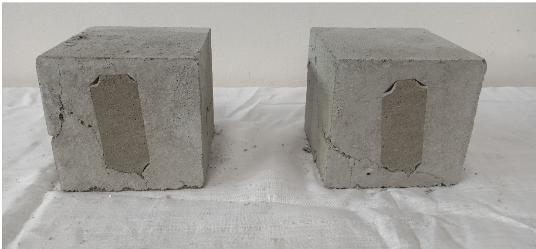
Obr. 24: Porušené krychle po pevnostní zkoušce, RF500
