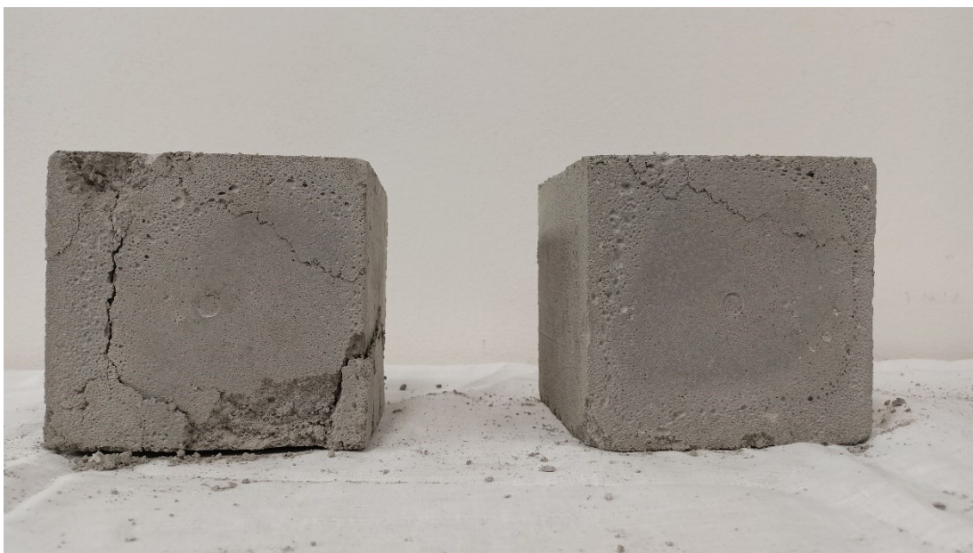
Obr. 27: Porušené krychle po pevnostní zkoušce, RF900
