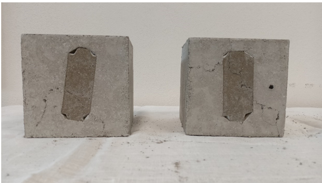
Obr. 31: Porušené krychle po pevnostní zkoušce, CF500+plast
