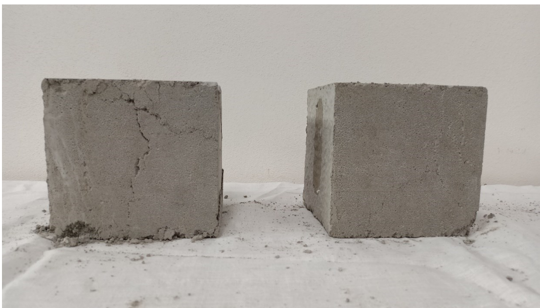
Obr. 28: Porušené krychle po pevnostní zkoušce, RF900
