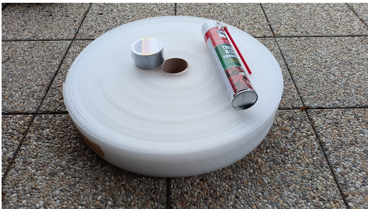
Obr. 40: Pěnový polyetylen (XPE), Polyuretanová pěna, izolační páska
