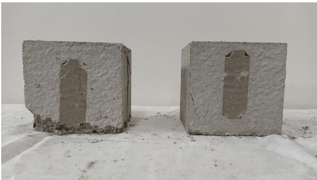
Obr. 25: Porušené krychle po pevnostní zkoušce, RF900
