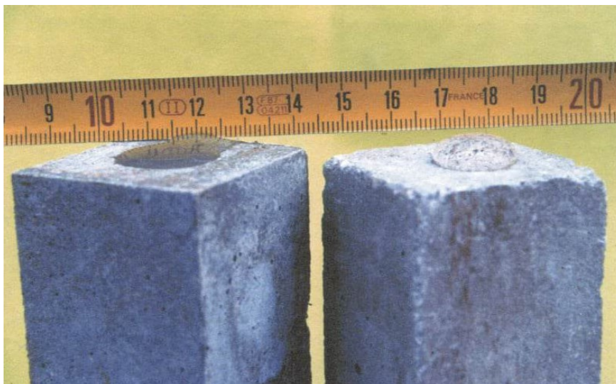
Obr. 1: Vlevo běžný beton a vpravo beton ošetřený hydrofobním postříkem [2]
