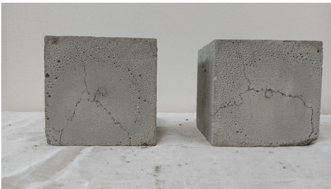
Obr. 21: Porušené krychle po pevnostní zkoušce, CF500
