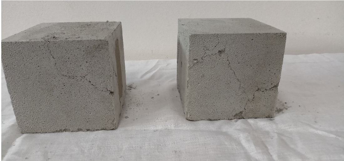
Obr. 23: Porušené krychle po pevnostní zkoušce, RF500
