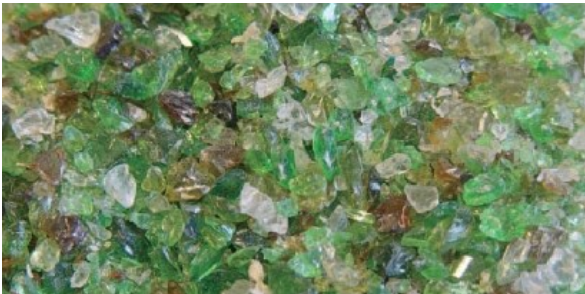
Obr. 4: Kamenivo v podobě nadrceného recyklovaného skla [20]
