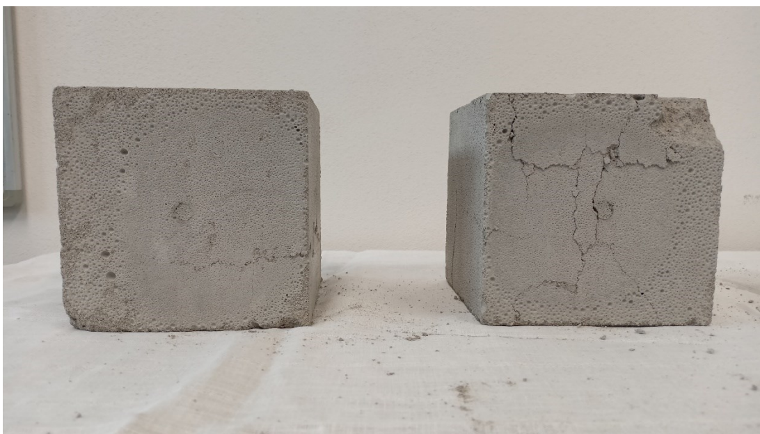
Obr. 30: Porušené krychle po pevnostní zkoušce, CF500+plast
