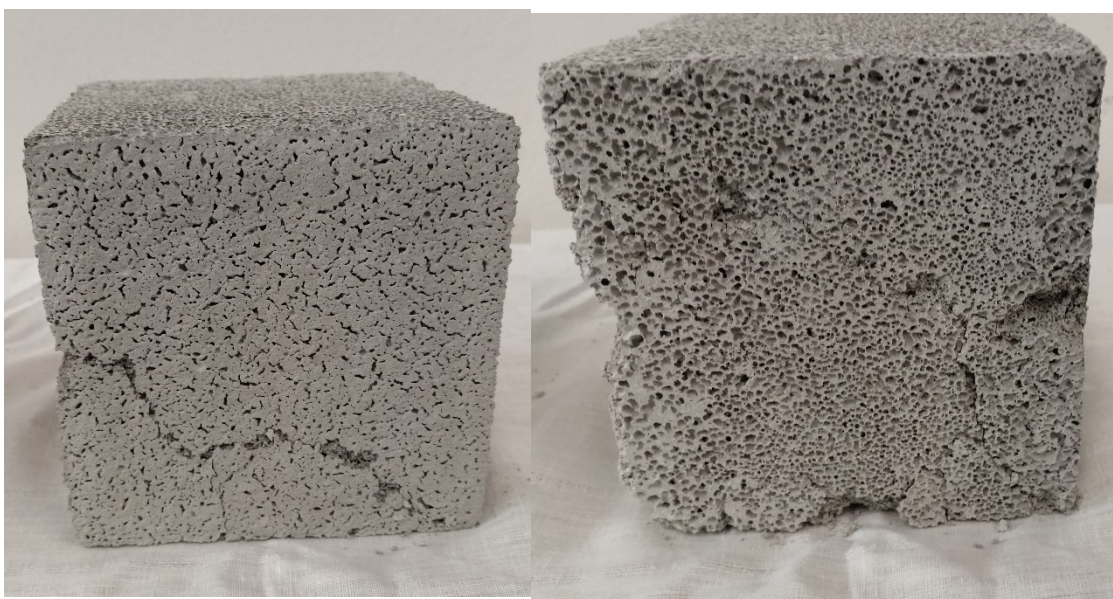
Obr. 18: Porušená krychle po pevnostní zkoušce, CF300
