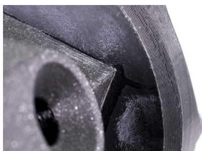
Obrázek 2: Bělavé skvrny od kyanoakrylátového adhezivního prostředku okolo lepeného spoje. [41]
