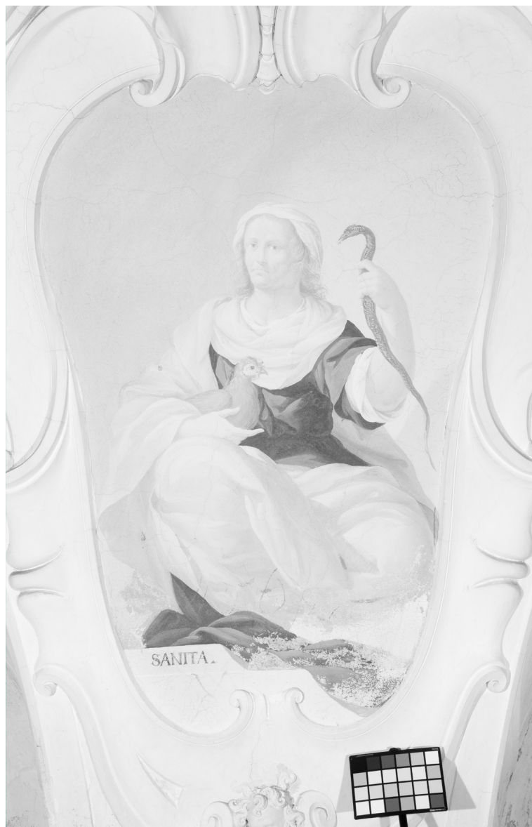
Obr. 27: Výjev Zdraví - IR reflektografie (IRR). Výrazně tmavší zelená draperie může být důsledkem pohlcování IR záření použitým pigmentem.
