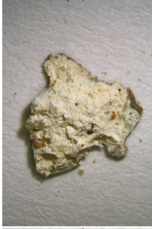
Obr. 40 a, b: Makrosnímek vzorku V17 (10173) z lícové (a) a rubové strany (b) vzorku. Snímek v odraženém bílém světle ze stereomikroskopu SMZ800 (Nikon) při zvětšení na mikroskopu 2x.
