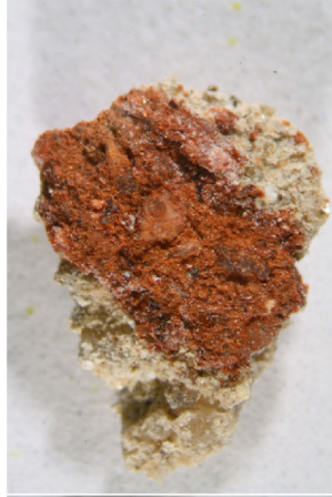
Obr. 24 a, b: Makrosnímek vzorku V7 (10032) z lícové (a) a rubové strany (b) vzorku. Snímek v odraženém bílém světle ze stereomikroskopu SMZ800 (Nikon) při zvětšení na mikroskopu 1,5x. Červená vrstva je cihlový podklad.
