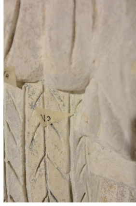
Obr. 3 a, b: Detaily míst odběru vzorků V3 (vlevo) a V4 (vpravo) pro chemicko-technologický průzkum. Pravý anděl, pravé křídlo anděla, modro-zelená (V3), pravý anděl, draperie na pravé ruce, okrovo-hnědá (V4).
