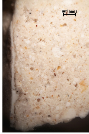
Obr. 34 a, b: Mikrosnímek vzorku V13 (10145) z licové (a) a rubové strany (b) vzorku. Snímek v odraženém bílém světle ze stereo-mikroskopu SMZ800 (Nikon) při zvětšení na mikroskopu 1x.
