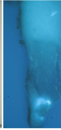
Obr. 13 a-d: Stratigrafie povrchových úprav vzorku V3 (9883). Popis: a) snímek v odraženém světle z optického mikroskopu Nikon LV 100 při zvětšení na mikroskopu 200x, c, d) snímky v UV a modrém světle, b) snímek ze skenovacího elektronového mikroskopu SEM MIRA3-LMU (TESCAN) v režimu zpětné odražených elektronů (BSE), 20 kV.
