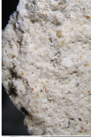
Obr. 34 a, b: Mikrosnímek vzorku V13 (10145) z licové (a) a rubové strany (b) vzorku. Snímek v odraženém bílém světle ze stereo-mikroskopu SMZ800 (Nikon) při zvětšení na mikroskopu 1x.
