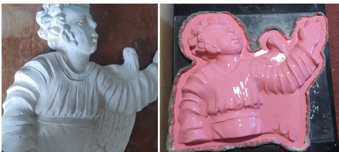
Obr. 17 Sadrový odliatok vo veľkosti 1:1 s originálom na ľavej strane fotografie, z ktorého bola následne vytvorená silikónová forma.
