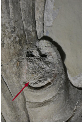
Obr. 10: Detail místa odběru vzorku V10. Pravá ruka anděla vlevo, v místě defektu, souvrství modeliční a jádrové vrstvy štuků.
