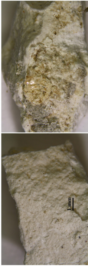
Obr. 38 a, b: Makrosnímek vzorku V16 (10172) z licové (a) a rubové strany (b) vzorku. Snímek v odraženém bílém světle ze stereomikroskopu SMZ800 (Nikon) při zvětšení na mikroskopu Ix.
