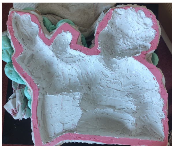
Obr. 18 Nanesenie tenkej modelačnej vrstvy do silikónovej formy.
