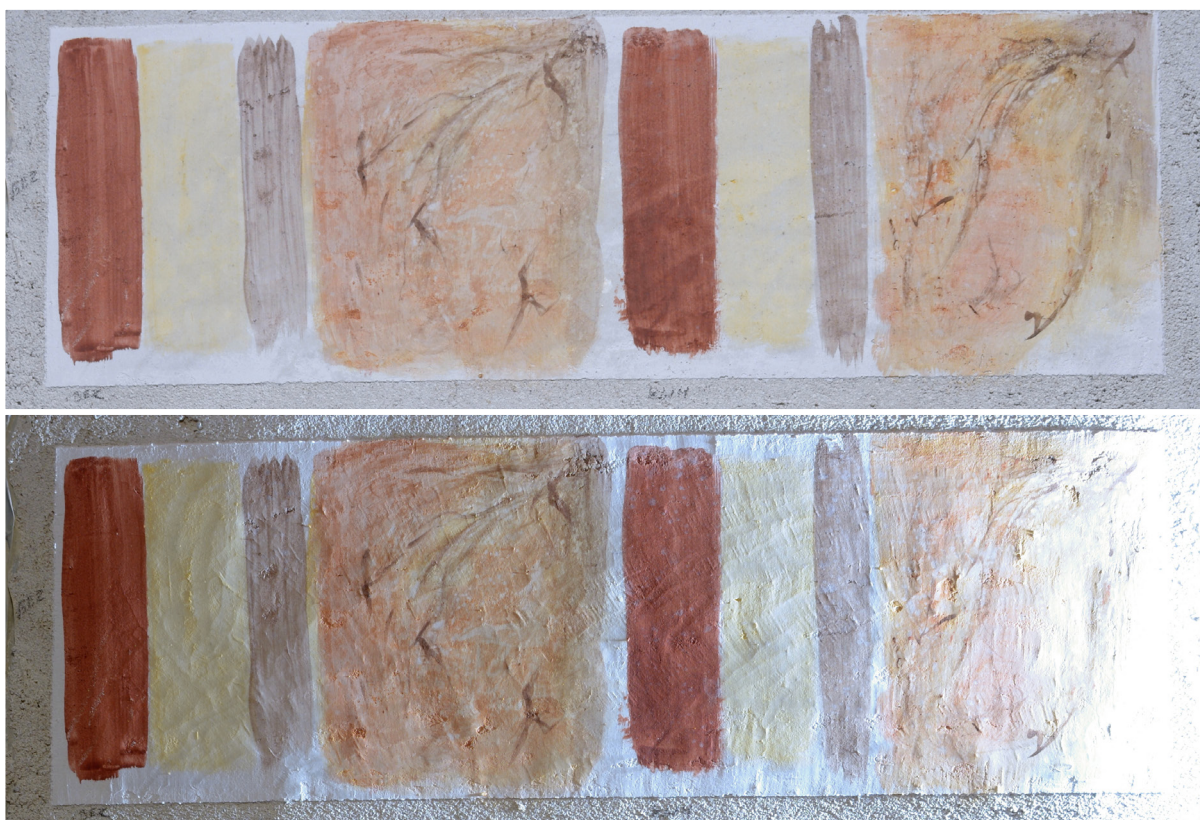
Obr. 21 Použitie receptu na suchej modelačnej vrstve s riedením čistou vodou alebo 6 % (hm.) glejovou vodou. Modelačná vrstva bola pri nanášaní kletovaná kovovou špachtľou. Ťahy kletovania je možné pozorovať na spodnej fotografii, vyfotenej v ostrom bočnom nasvetlení.
