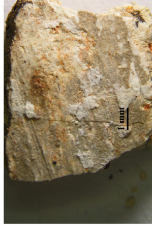
Obr. 46 a, b: Makrosnímek vzorku V20 (10176) z lícové (a) a rubové strany (b) vzorku. Snímek v odraženém bílém světle ze stereomikroskopu SMZ800 (Nikon) při zvětšení na mikroskopu 1x.
