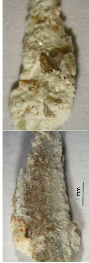
Obr. 3 a, b: Makrosnímek vzorku V.1 (9881) z lícové (a) a rubové strany (b) vzorku. Snímek v odraženém bílém světle ze stereomikroskopu SMZ800 (Nikon) při zvětšení na mikroskopu 2x.
