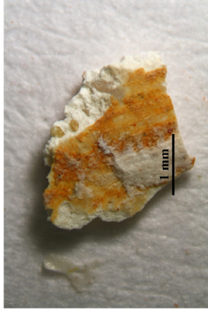
Obř. 48 a, b: Makrosnímek vzorku V21 (10177) z lícové (a) a rubové strany (b) vzorku. Snímek v odraženém bílém světle ze stereomikroskopu SMZ800 (Nikon) při zvětšení na mikroskopu 1x.
