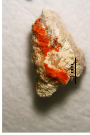
Obr. 44 a, b: Makrosnímek vzorku V19 (10175) z lícové (a) a rubové strany (b) vzorku. Snímek v odraženém bílém světle ze stereomikroskopu SMZ800 (Nikon) při zvětšení na mikroskopu 2x.
