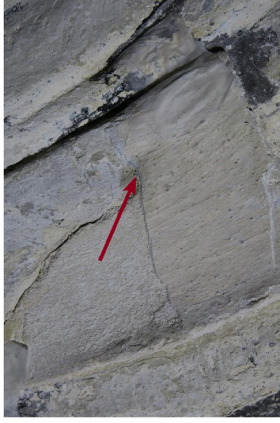
Obr. 9: Detail místa odběru vzorku V9 pro chemicko-technologický průzkum. Konec šály (pentle) Rosiny, tmel s vrstvami druhotných nátěrů.
