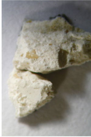
Obr. 17 a, b: Makrosnímek vzorku V5 (9885) z licové (a) a rubové strany vzorku (b). Snímek v odraženém bílém světle ze stereomikroskopu SMZ800 (Nikon) při zvětšení na mikroskopu 2x.
