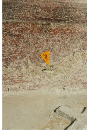
Obr. 17: Detail místa odběru vzorku V17 pro chemicko-technologický průzkum: Tympanon, pravá část, tmel žulý s červenou barevnou
