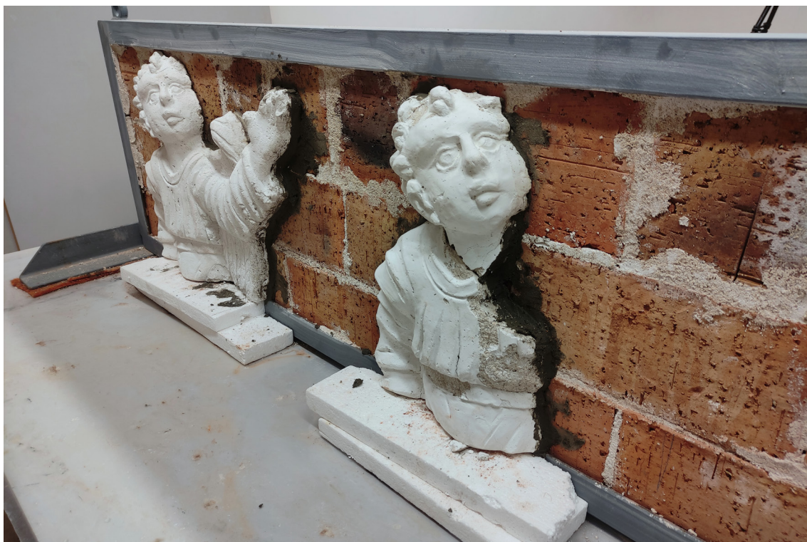
Obr. 108 Štukové kópie prichytené k prenosnej stene pomocou armatúry a cementového lepidla.
