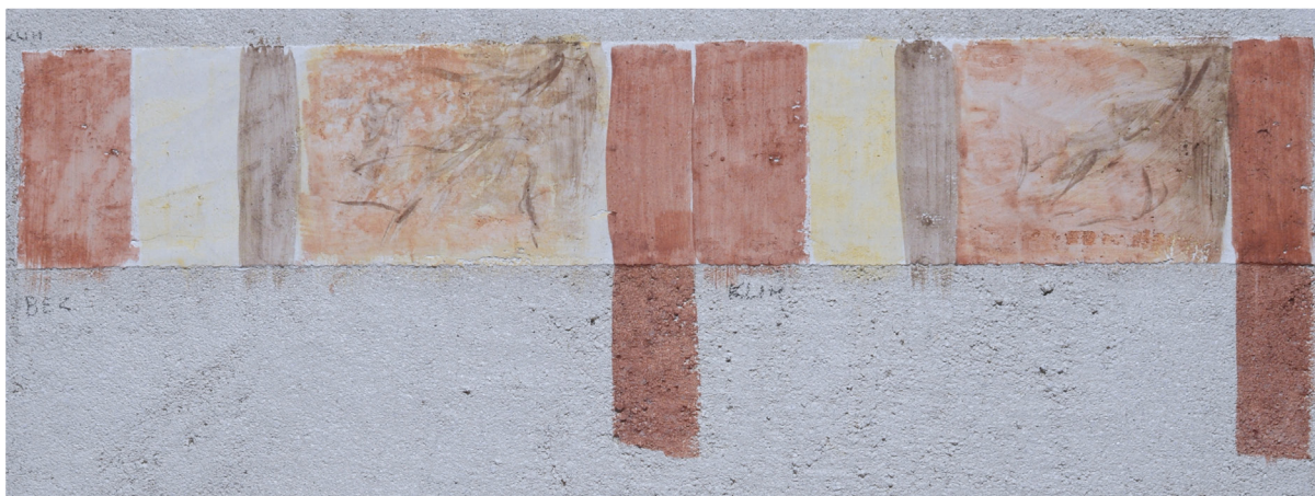
Obr. 22 Použitie receptu na suchej modelačnej vrstve s riedením čistou vodou alebo 6% (hm.) glejovou vodou. Modelačná vrstva bola pri nanášaní kletovaná kovovou špachtľou a po uschnutí izolovaná 6% (hm.) glejovou vodou.
