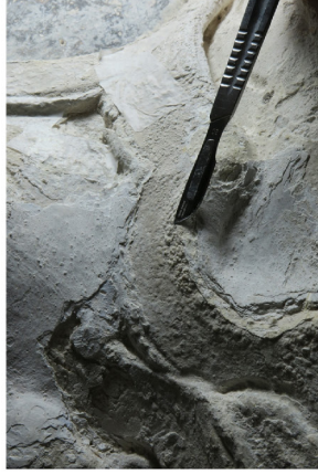
Obr. 14: Detail místa odběru vzorku V14 (S1) pro chemicko-technologický průzkum: Pířba, seškrab solných výkvětů na sekundárním doplňku.
