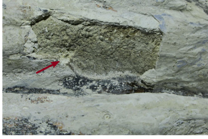
Obr. 8 a, b: Detail místa odběru vzorku V8 pro chemicko-technologický průzkum. Kalhoty staršího chlapce, štukové souvrství s černou barevnou úpravou.
