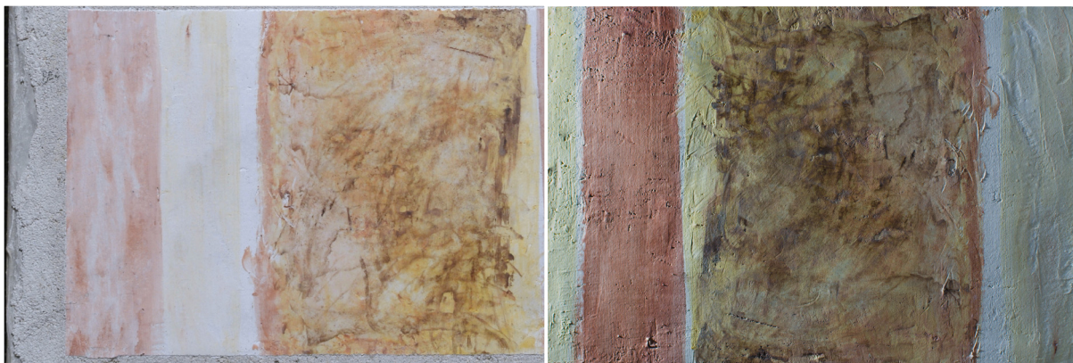
Obr. 23 Použitie vápenného kazeínu do čerstvej modelačnej vrstvy v dennom odrazenom svetle (v ľavo) a ostrým bočnom nasvietení (v pravo).
