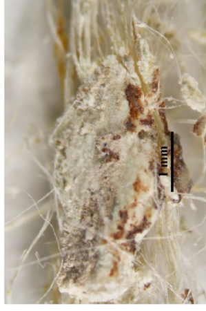
Obr. 50: Makrosnímek vzorku V22 (10178) z lícové strany vzorku (vlevo) a detail vláken (vpravo). Snímek v odraženém bílém světle ze stereomikroskopu SZ2800 (Nikon) při zvětšení na mikroskopu 2x a 5x. Vlevo detail štuků se zbytky dochované polychromie v růžové a hnědo-červené barevnosti.
