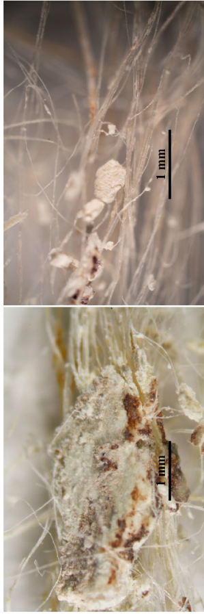
Obr. 59: Mikrosnímek vzorku V22 (10178) z lícové strany vzorku (vlevo) a detail vláken (vpravo). Snímek v odraženém bílém světle ze stereoskopu SZ2800 (Nikon) při zvětšení na mikroskopu 2x a 5x.
