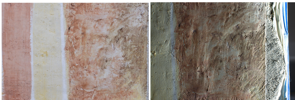
Obr. 24 Použitie vápenného kazeínu s modifikáciou pomocou 6% (hm.) glejovej vody, na čerstvej modelačnej vrstve v dennom odrazenom svetle (v ľavo) a ostrým bočnom nasvietení (v pravo).
