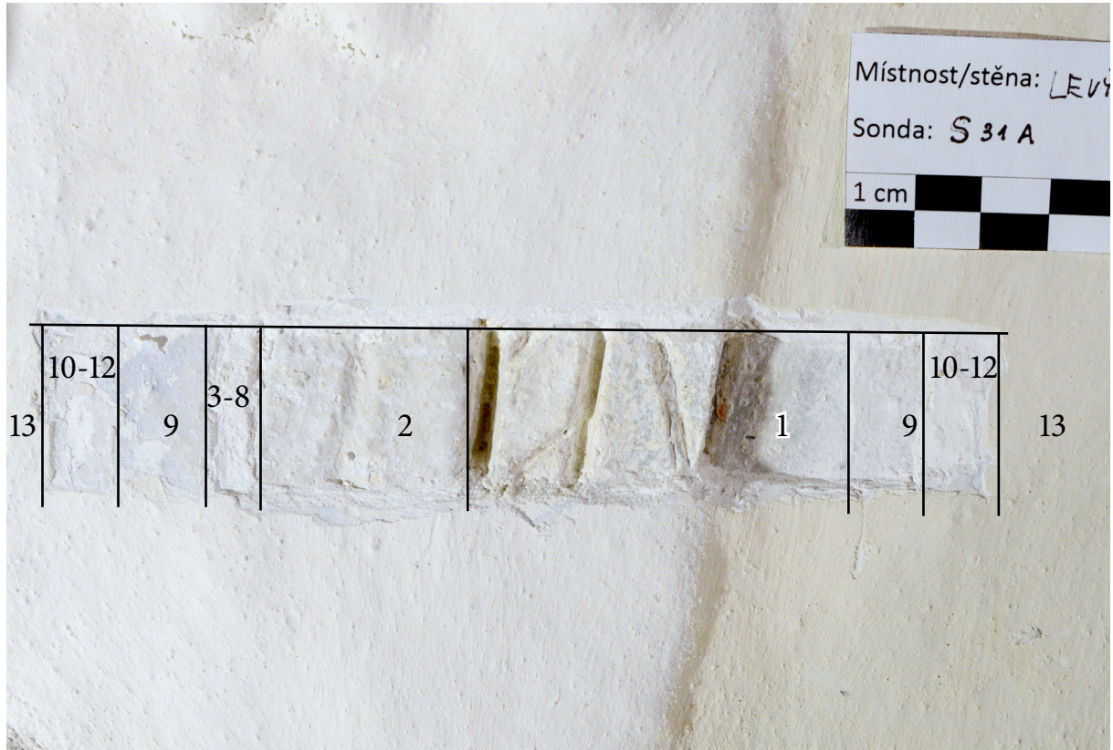
Obr. 04 Fotografia sondy na ľavom anjelovi s označením poradia vrstiev, ktoré na danom mieste bolo možné odhaliť.
