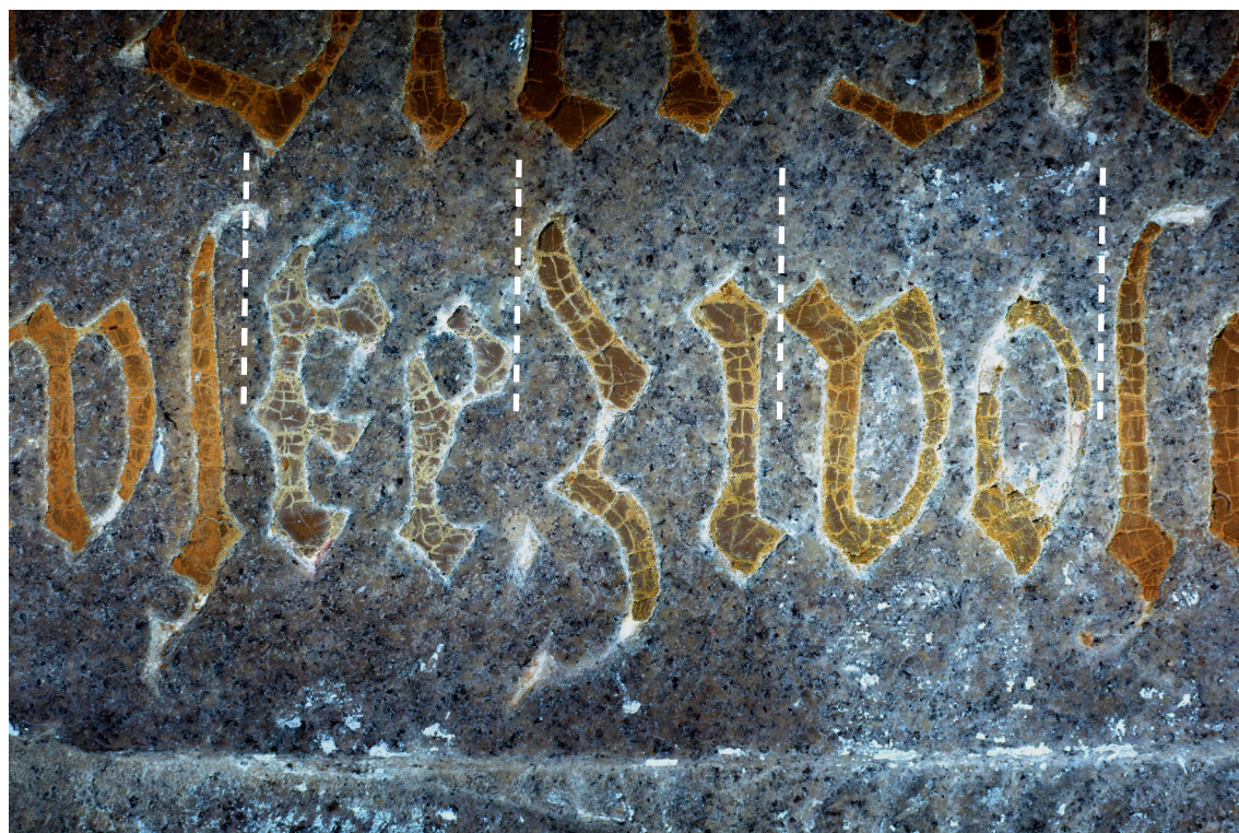
Obr. 74 Pozorovanie skúšok roztoku pre konsolidáciu pôvodného materiálu výplne písma v žulovej doske pod UV žiarením.
