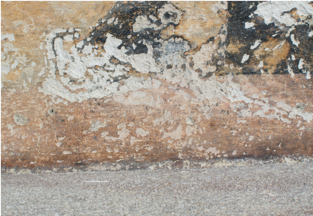
Obr. 69 Prevedenie skúšok v dennom prirodzenom svetle s použitím dvojitéžďhovej zmesi arabskej gummy s prídavkom zinkovej beloby s minerálnymi pigmentmi. Skunka bola prevedená na pozadí centrálného výjavu vľavo od kríža.
