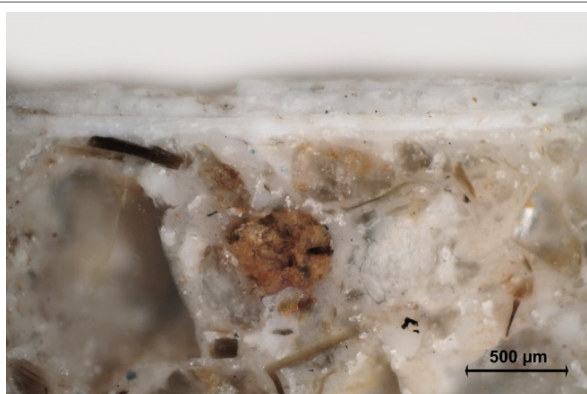
Bílé dopadající světlo, povrch omítky s nátěry, fotografováno při zvětšení mikroskopu 100x
