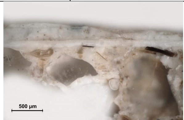
Bílé dopadající světlo, povrch omítky s nátěry, fotografováno při zvětšení mikroskopu 100x
