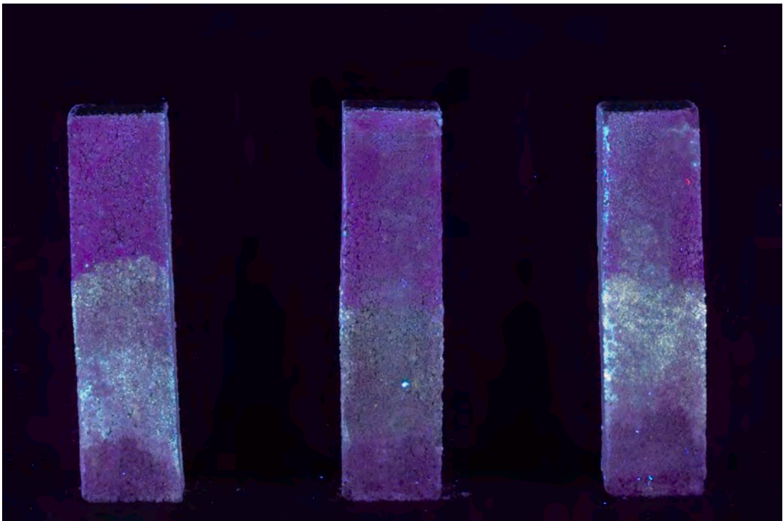
Obr. č. 47 Test č. 3 síran hořečnatý, UVF fotografie (boční pohled).
