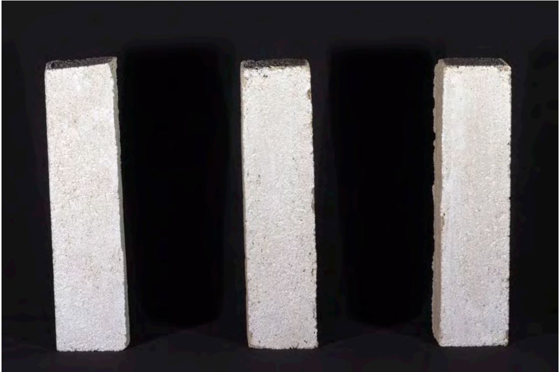
Obr. č. 70 Test č. 10 hexahydrát chloridu hořečnatého, na povrchu těles nebyla zaznamenána žádná eflorescence.
