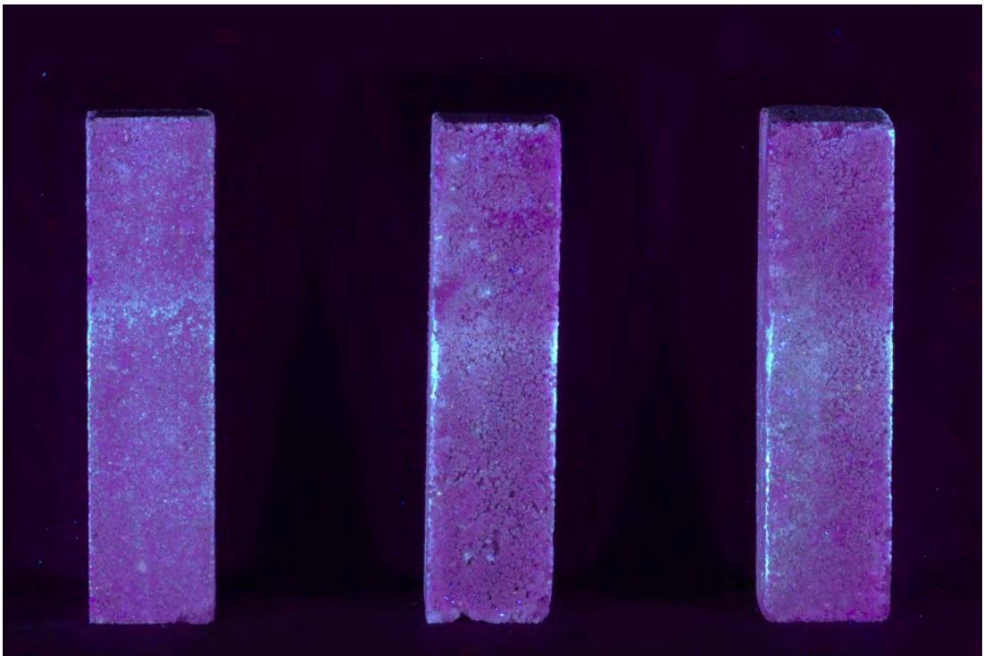
Obr. č. 43 Test č. 2 dihydrát síranu vápenatého, UVF fotografie (boční pohled).
