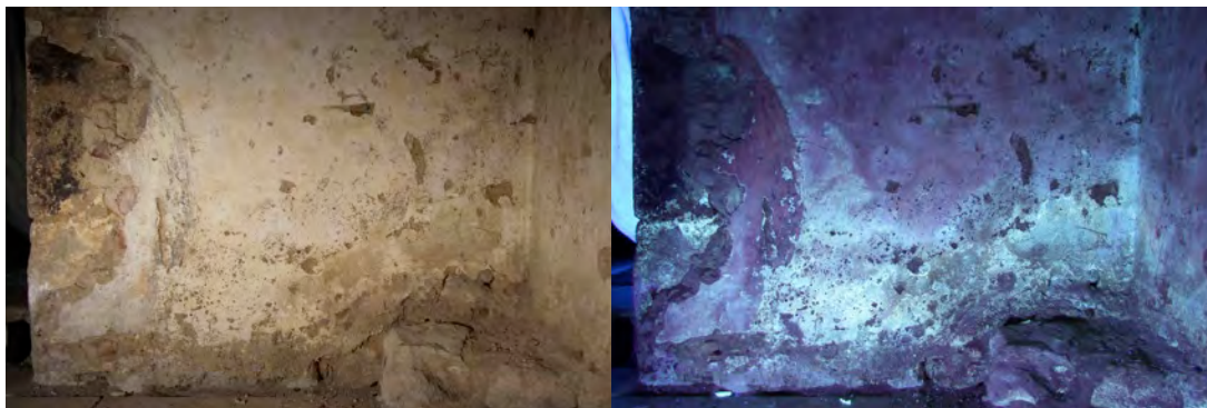
Obr. č. 7 VIS a UVF fotografie destruované omítky v kostele sv. Víta v Zahrádce. 98
