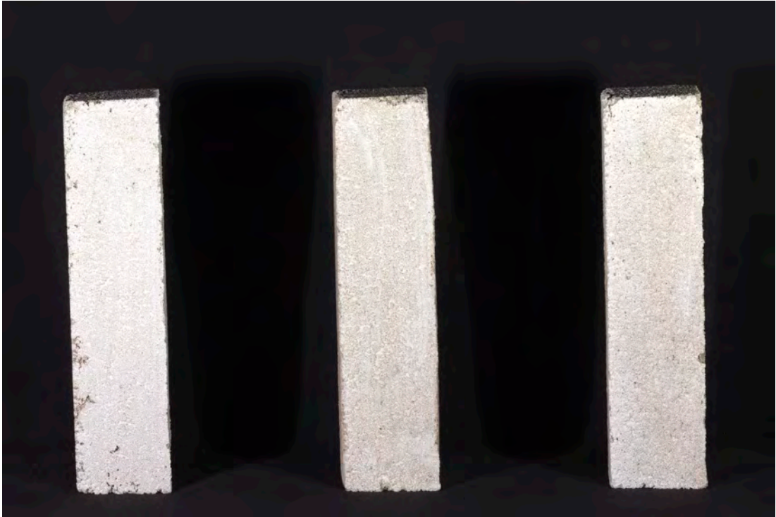
Obr. č. 68 Test č. 9 chlorid vápenatý, na povrchu těles nebyly zaznamenány žádné eflorescence solí.
