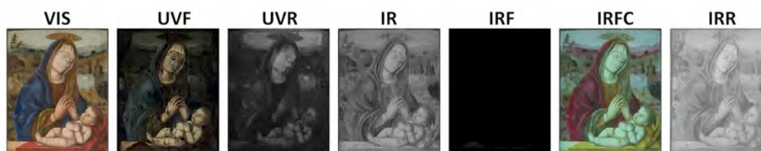
Obr. č. 13 Sada snímků používaných pro multispektrální zobrazování. 156
