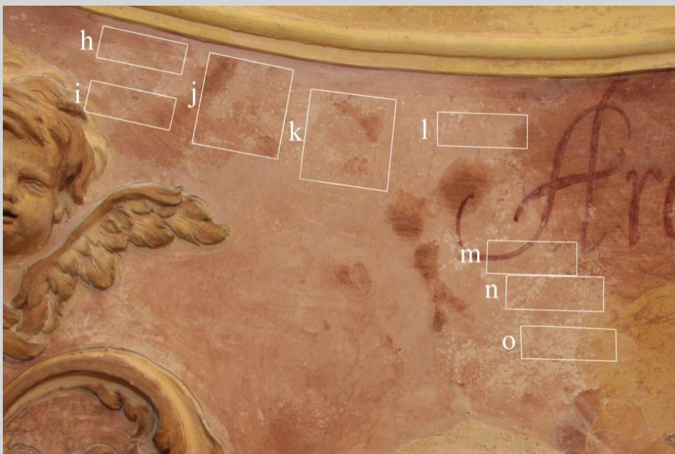
Zkoušky zpevňování vápennými suspenzemi a jejich směsi s estery kyseliny křemičité
