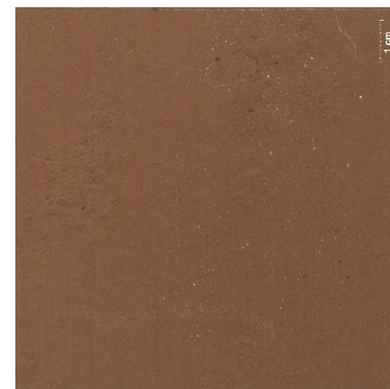
Snímek zkušebního pole C10 po zpevnění
