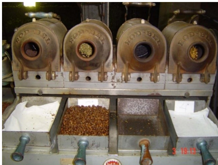
Obrázek 6: Pražírna s přímým plynovým spalováním. Převzato z: [26].
