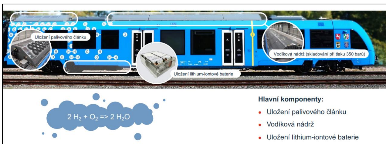
Obrázek 2 Základní komponenty HMU jednotky Coradia iLint od výrobce Alstom
