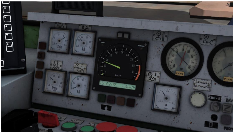
Obrázek 34 Lokomotiva řady 714 jedoucí na jeden motor (viz ampérmetry) (autor s využitím TSC)
