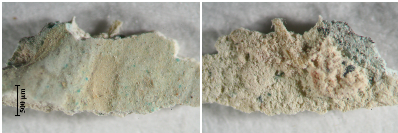
Obr. 2 a, b: Makrosnímek vzorku VI (9801) z líčové a rubové strany vzorku. Snímek v odraženém bílém světle ze stereomikroskopu SMZ800 (Nikon) při zvětšení na mikroskopu 1,5x.
