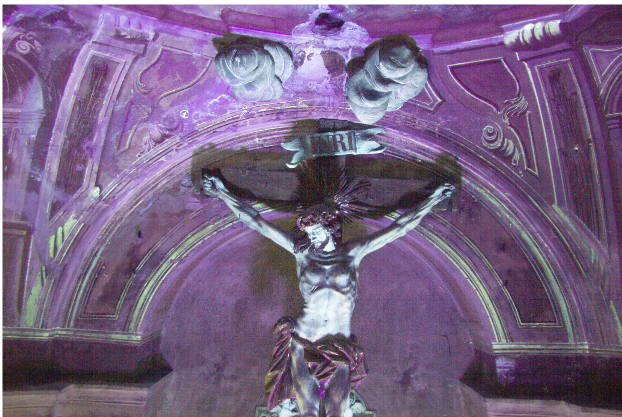
Obr. 14: Přemalba z 19. století ve zdroji UV záření. Stav před restaurováním. Žlutozelenou luminiscenci vykazuje lineární členění architektury, nafialovělou pak vápno obsažené v omítce a jako pojivo barevných vrstev.
