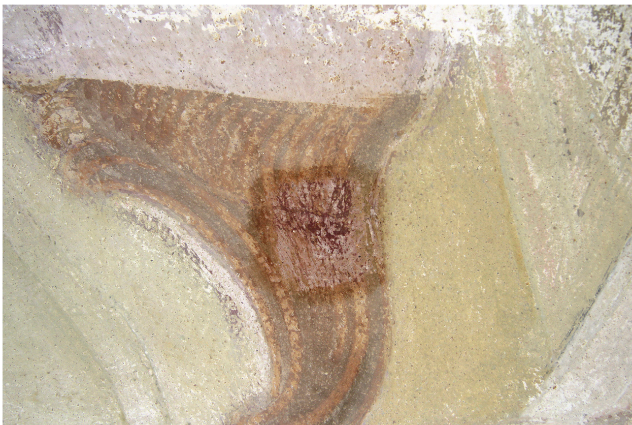
Obr. 47: Zkouška čištění 20% (hm.) uhličitánem amonným pomocí obkladů z buničinových plátků 2 × 2 cm. Lastura nad iluzivní nikou, jižní kout kaple
