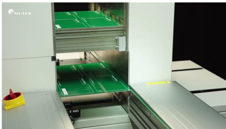
Obrázek 12 - Ukázka destackeru s pneumatickým zdvihákem [56]
