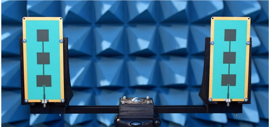
Obrázek 7.24 Dva vysílací anténní elementy v nastavení pro MIMO
