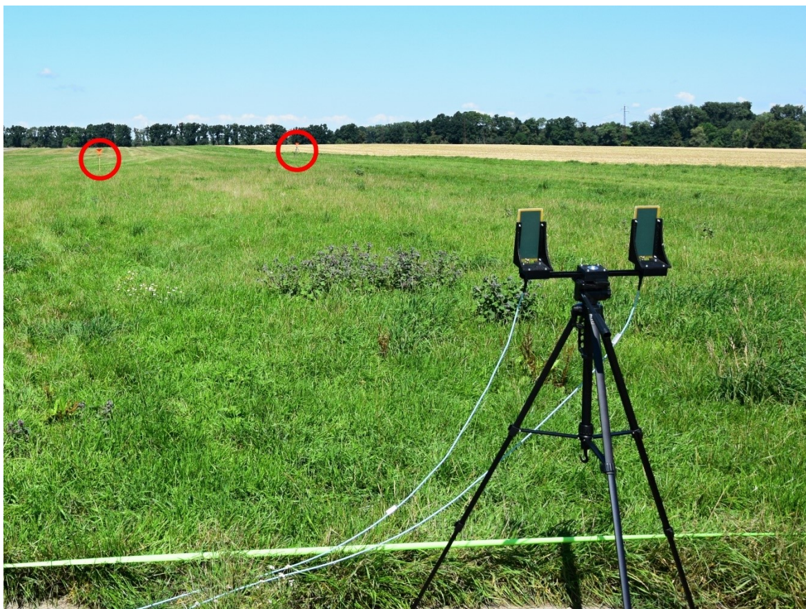
Vysílací anténa a koutové odražeče (50 m a 100 m)
