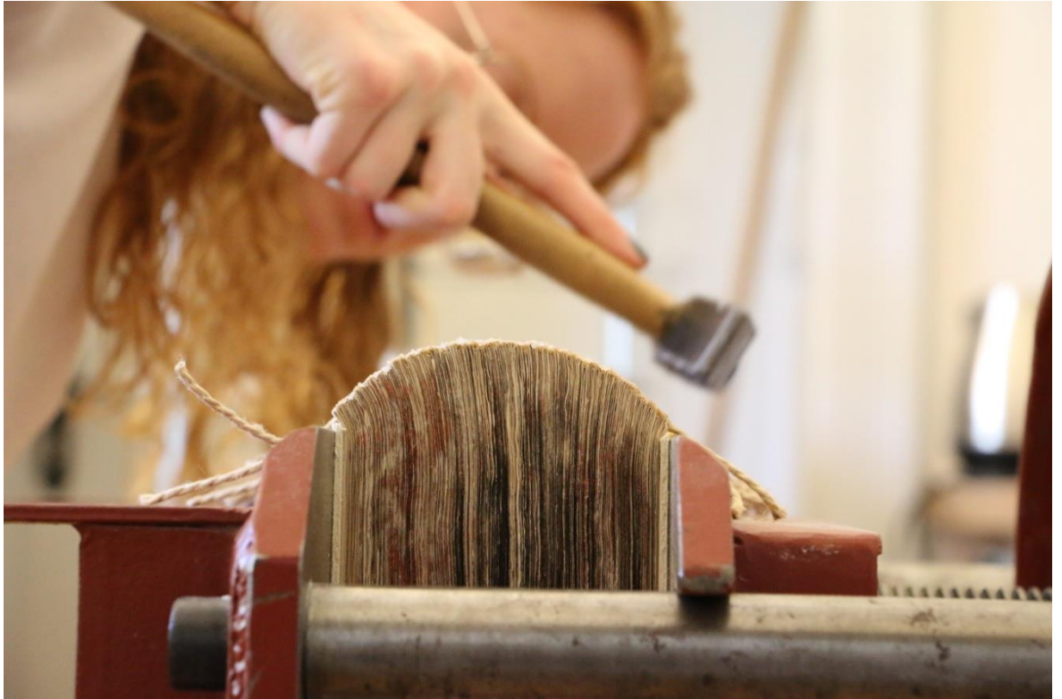
Obrázek 67 Kulacení knižního hřbetu
