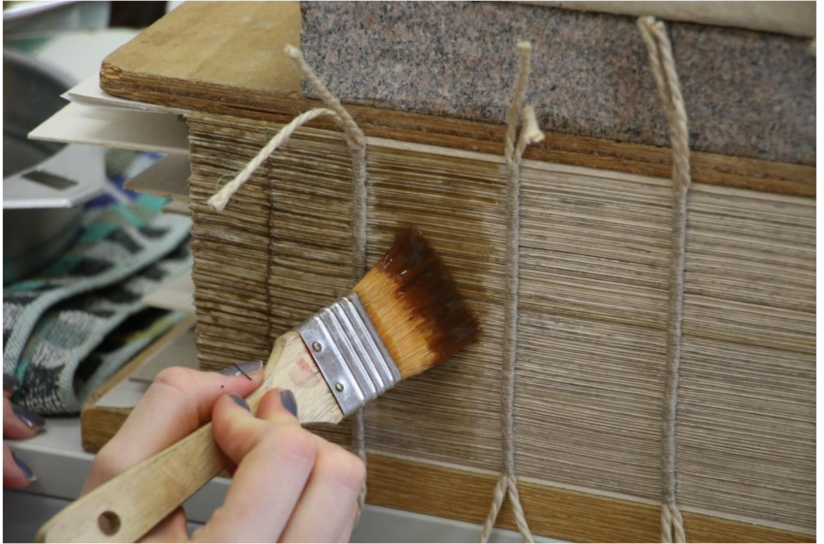
Obrázek 65 Klížení knižního hřbetu
