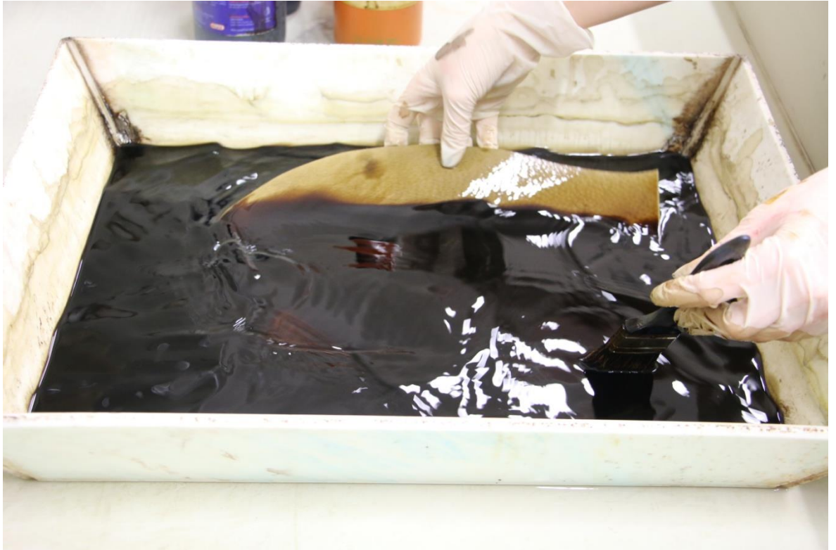
Obrázek 87 Moření nové usně
