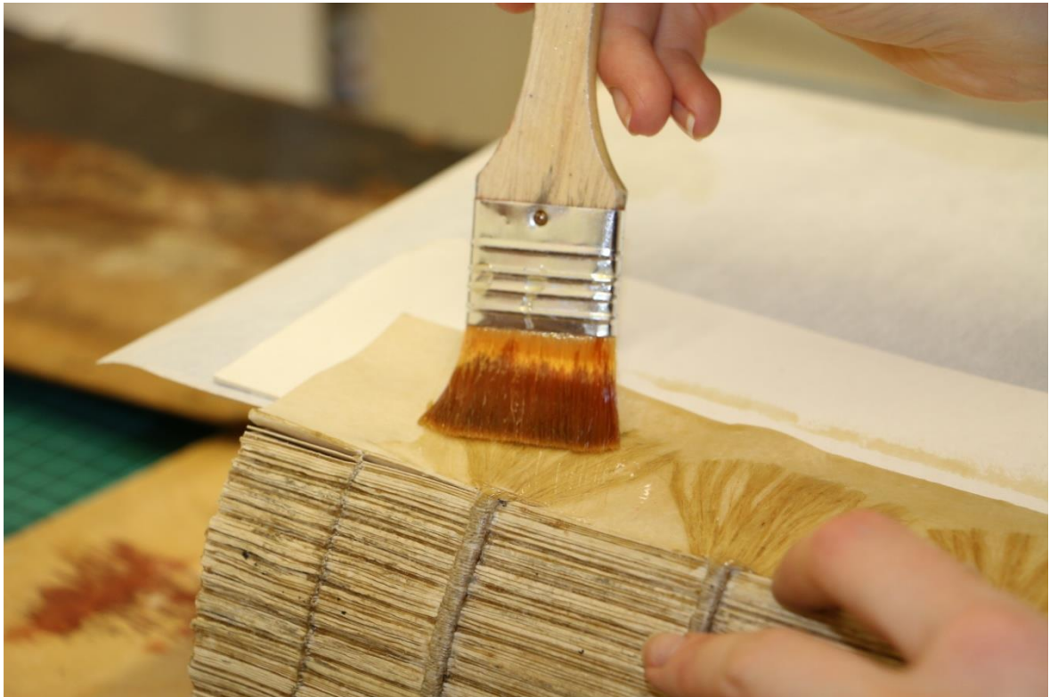
Obrázek 82 Natírání křidélek kličem pro nasazení desky
