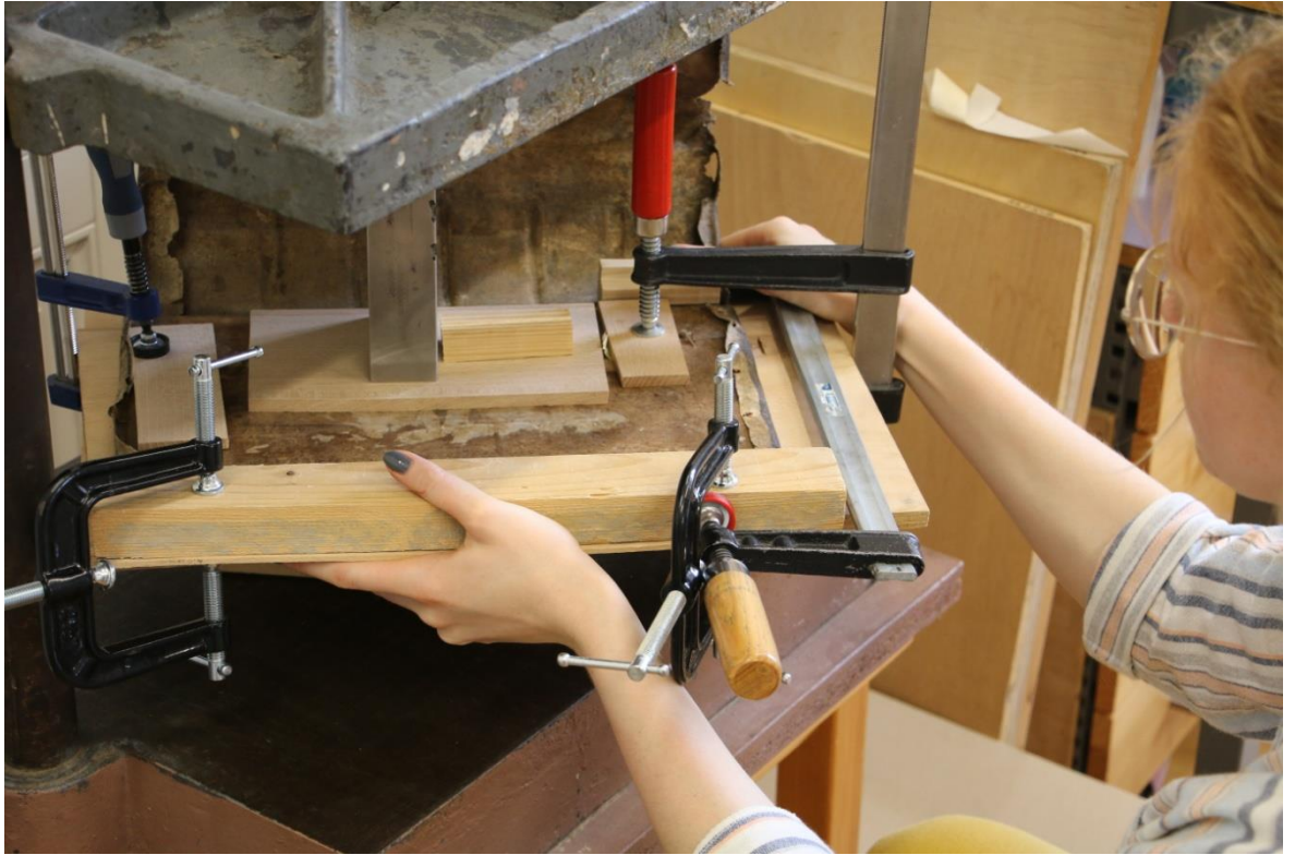
Obrázek 81 Fixování spoje zadní desky
