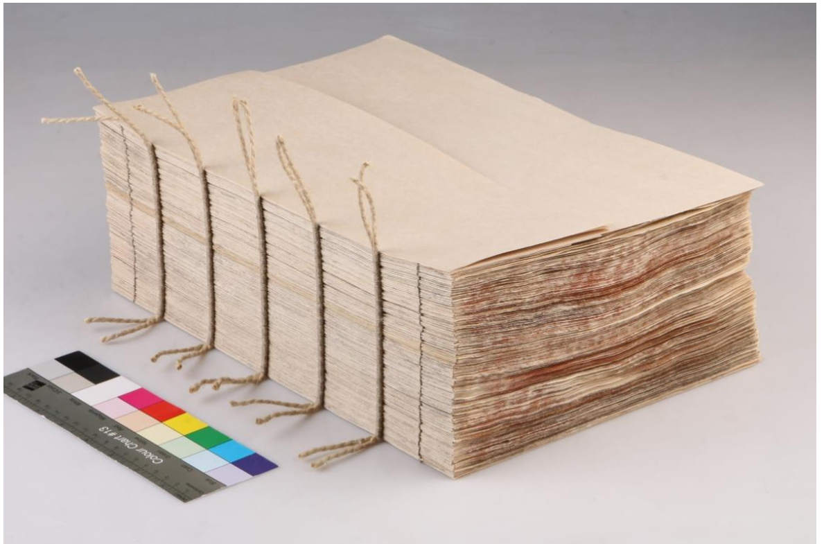
Obrázek 39 Knižní blok po vyšití
