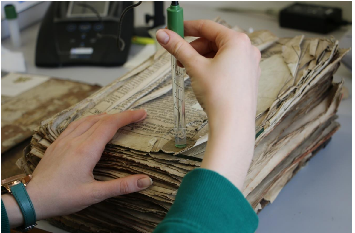
Obrázek 49 Odebírání vzorků pro odborné analýzy
