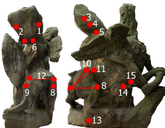
Obrázek 1 místa měření ultrazvukovou transmisí
