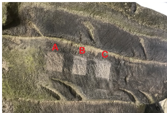
obrázek 6 zkoušky redukce černého povlaku
