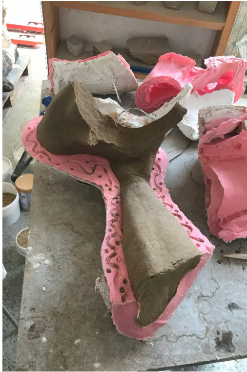
Obrázek 109 vyndávání výdusku, z umělého kamene, z formy
