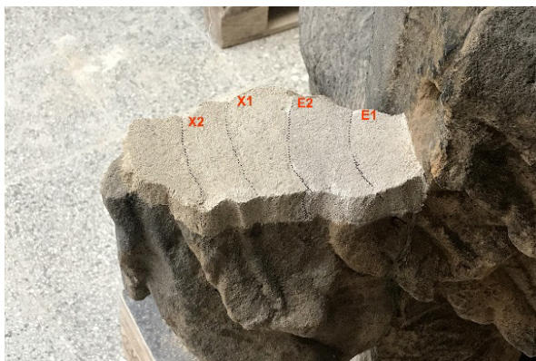
obrázek 10 zkoušky tmelů na lomovém povrchu originálního materiálu
