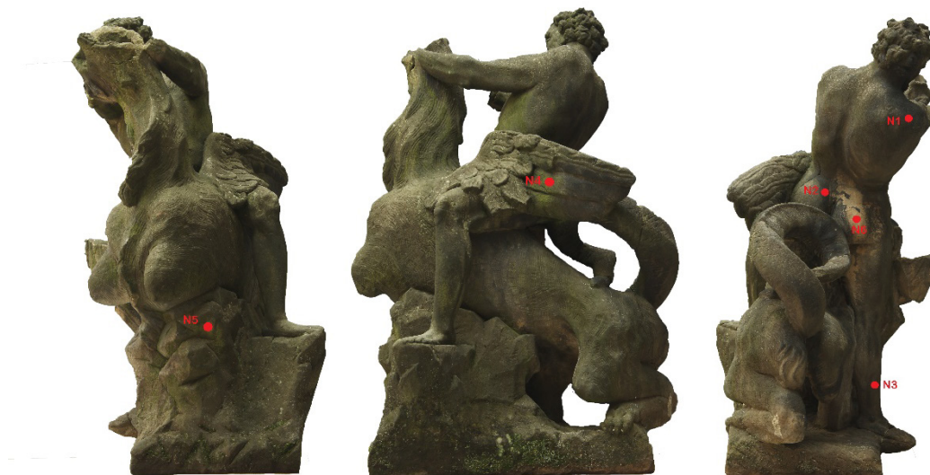
obrázek 4 grafické znázornění míst se zkouškami nasákavosti
