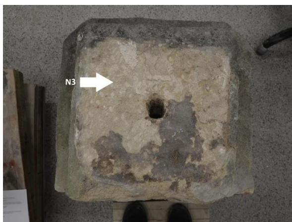
Obrázek 7- Grafické znázornění místa měření nasákavosti – N3
