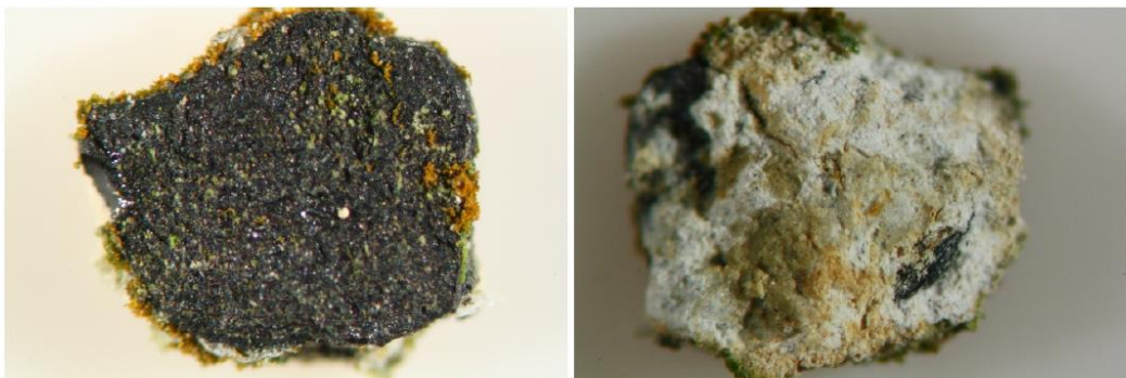
Obr. 12 a-b: Makosnímek líčové a rubové strany vzorku. Snímky ze stereomikroskopu SMZ800, fotografováno při zvětšení 3x. Vzorek byl odebrán bez podkladu. Bázi vzorku tvoří bílý až sv. okrový nátěr, na povrchu se nachází mohutný a kryvý černý nátěr. Zelené a oranžové částice jsou patrně zbytky nižších rostlin.
