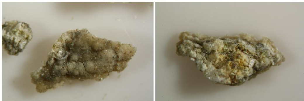
Obr. 18 a-b: Makosnímek líčové a rubové strany vzorku. Snímky ze stereomikroskopu SMZ800, fotografováno při zvětšení 2x. Vzorek horniny s tmavým uzavřeným povrchem. Na rubové straně jsou viditelná zrna horniny a zelené řasy mezi nimi.
