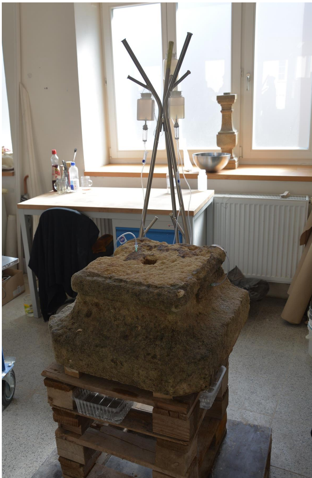
Obrázek 61 – Konsolidace pomocí infuzí – průběh zpevňování
