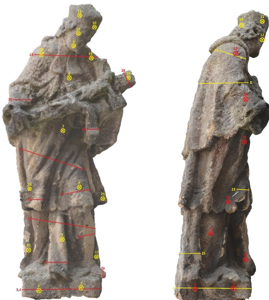
Obrázek 10 – Grafický zakres míst měřených ultrazvukovou transmisí – boční pohled figury
