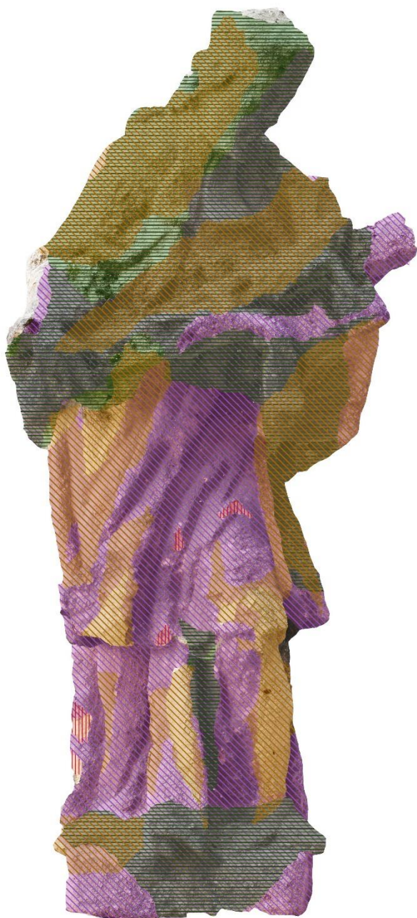
Obrázek 29 – Grafický zakres poškození, figura – přední strana
