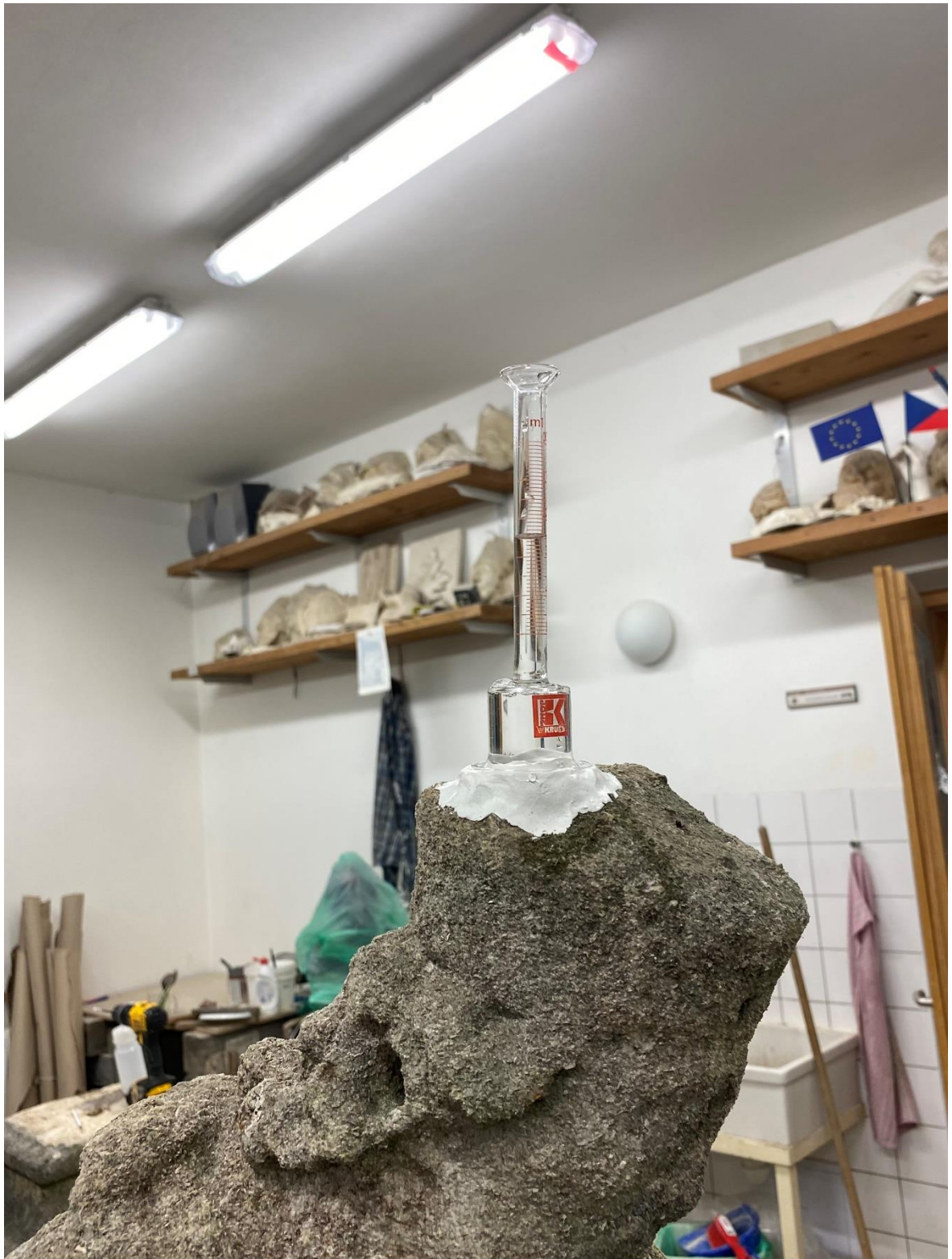
Obrázek 58 – Měření nasákavosti pomocí Karstenovy trubice
