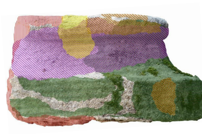
Obrázek 26 – Grafický zákres poškození, podstavec – levá strana
