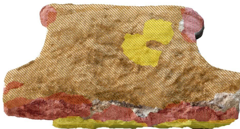
Obrázek 28 – Grafický zakres poškození, podstavec – zadní strana
