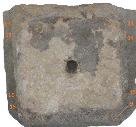
Obr. 7 a, b: Lokalizace míst měření rychlosti UZ transmise na podstavci plastiky sv. Jana Nepomuckého z Bylan. Hodnoty rychlosti UZ transmise před konsolidací jsou uvedeny v Tab. 2.
