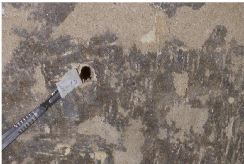
Obr. 41 Lokalizace odběru vzorků ke stanovení obsahů vlhkosti a vodorozpuštěných solí Z1, Z2, detail.
