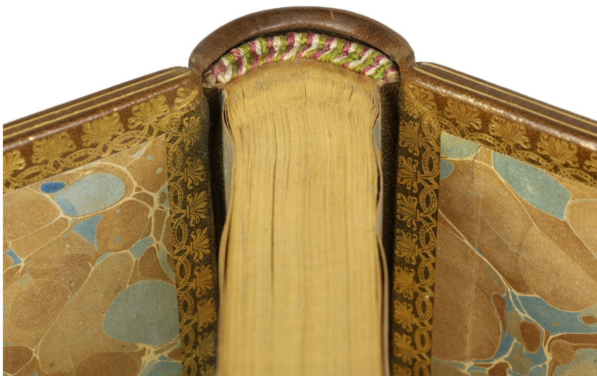
Obr. 101 Bližší pohled na hlavu knihy s formovanou hlavičká a ručně vyšitým kapitálkem nad zlacenou ořízkou
