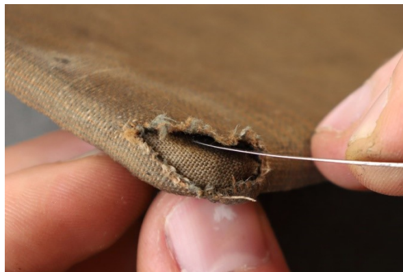
Obr. 276 Aplikace textilní záplaty v místě defektu knižního potahu v dolním rohu zadní knižní desky
