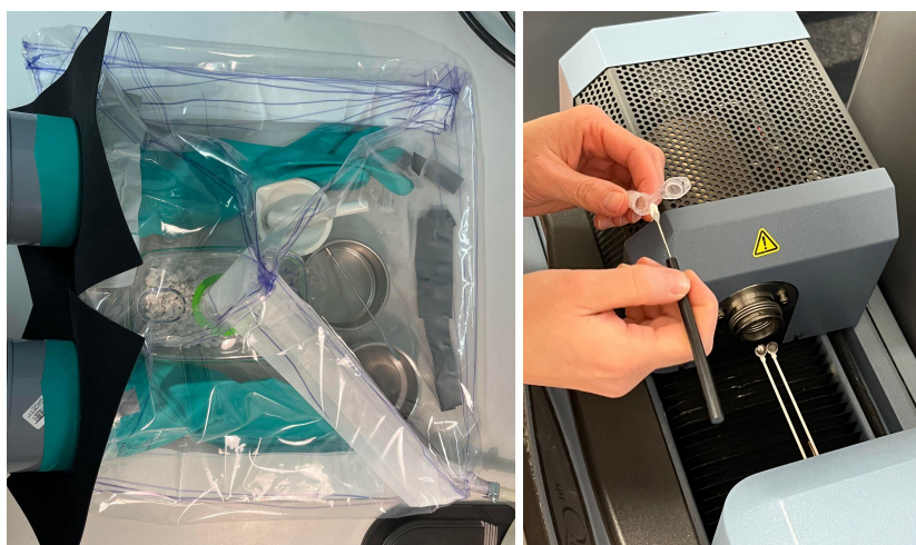
Obr 10–11: Vlevo: Rukavicový box s přívodem inertního plynu pro přípravu práškového vzorku k termické analýze. Vpravo: Přenesení práškového vzorku ze vzorkovnice do přístroje pro termickou analýzu SDT Q600.
