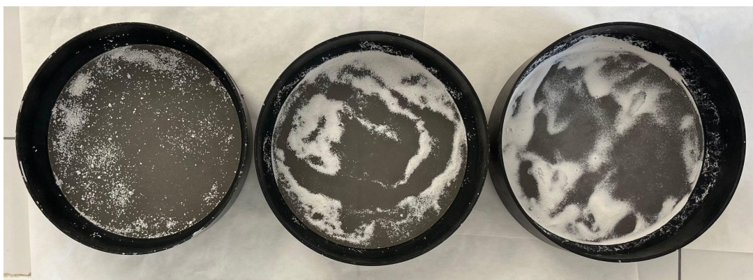
Obr. 12: Nehasitelný podíl zachycený na sítích s velikostí oka D 0,125, 0,25 a 0,5 mm (7d, prostředí: sklo). Částice jsou bílé a ztvrdlé.
