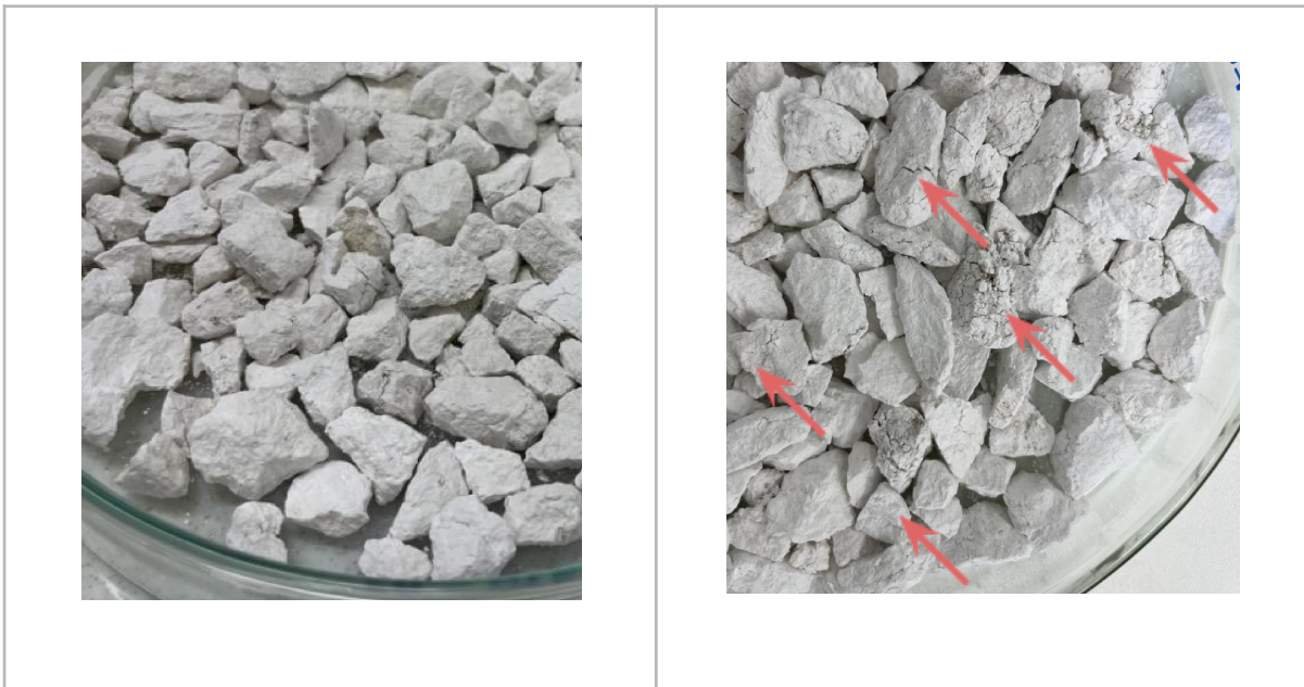
Obr. 14–15: Kusové pálené vápno uložené na vzduchu – srovnání vzhledu kousků vzorku po 1 (vlevo) a 28 dnech (vpravo). Po 28 dnech vznikají makrotrhliny, které způsobují rozpad vzorků a jejich práškovatění.
