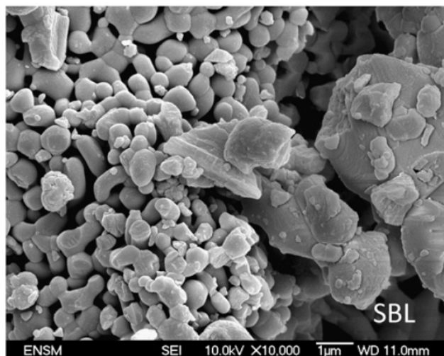
Obr. 3: Mikrostruktura CaO, v levé části je patrná typická porézní mikrostruktura tvořená částicemi amorfniho vzhledu. Napravo tvoří částice páleného vápna větší útvary tj. klastry, které vznikají vrstvením částic na sebe. 49
