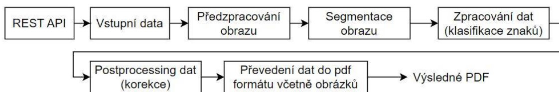
Obr. 36 - Ilustrace principu průchodu dat ICR pipeline (zdroj: vlastní)
