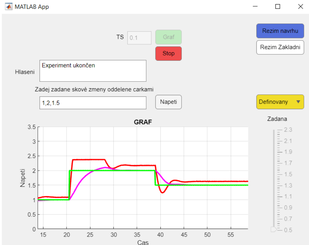
Obrázek 2.17 – Regulační pochod reálná soustava parametry 2 s T_s = 0,1s
