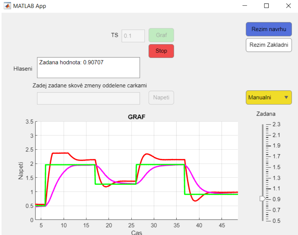
Obrázek 2.14 – Regulační pochod reálná soustava žádávána manuálně T_s=0,1s
