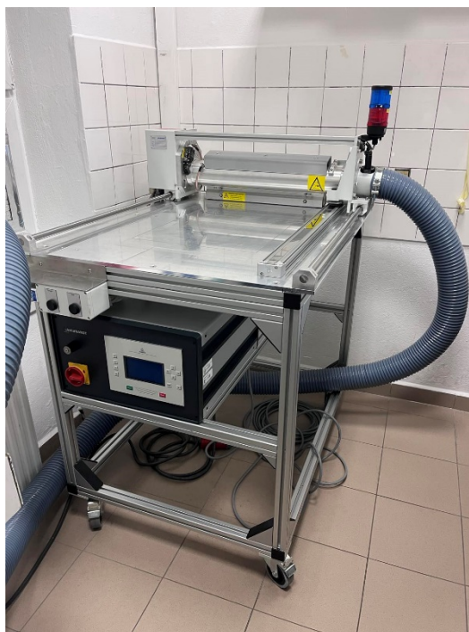
Obrázek 15: Koronovací zařízení Lab Treator ASL 400 TUM
