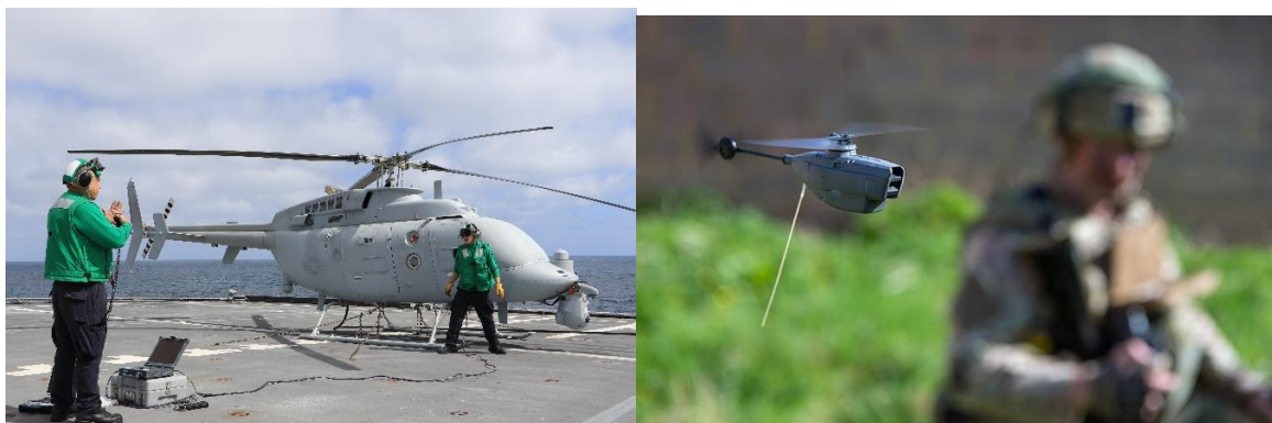
Obrázek 7: Srovnání velikostí vrtulníkůvých UAV MQ8 a Black Hornet (wikimedia)
