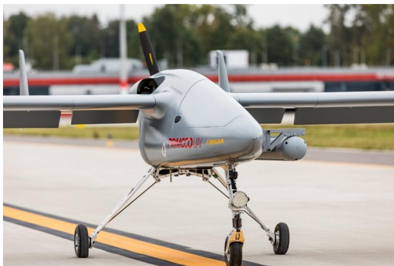
Obrázek 19: PRIMOCO UAV ONE s poděšeným radarem IMSAR (Primoco UAV)
