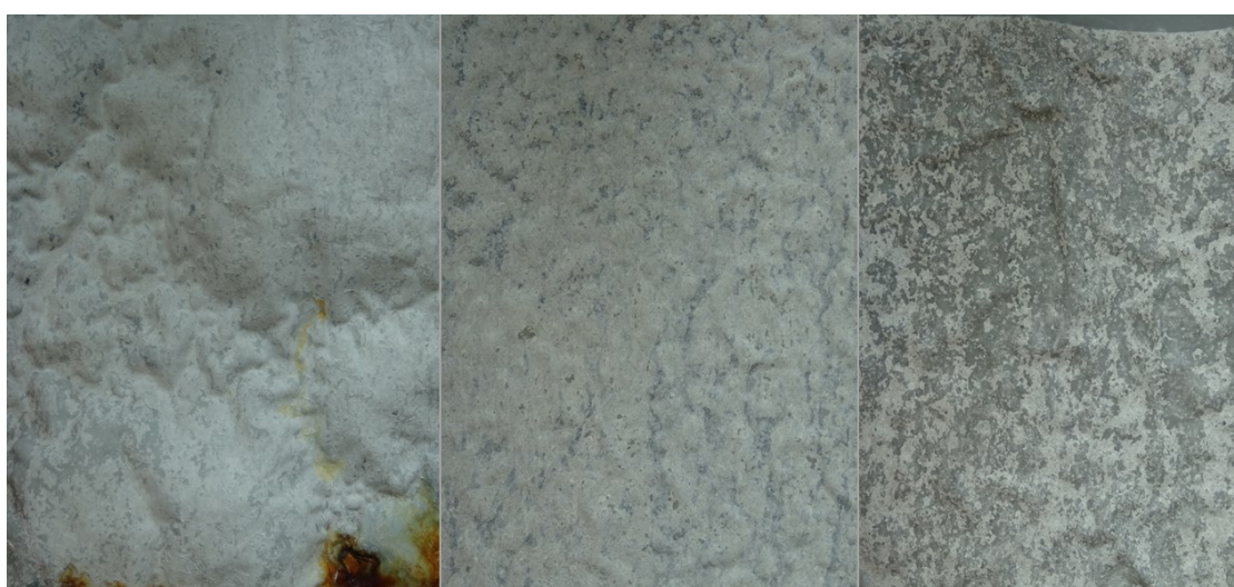
Obr. 22: Ukázka nátěrových filmů s obsahem CaCO 3 o koncentracích Q = 90 %, s obsahem zleva: Zn4P16, Zn10 a Zn15 po 504hodinové expozici neutrální solné mlže.
