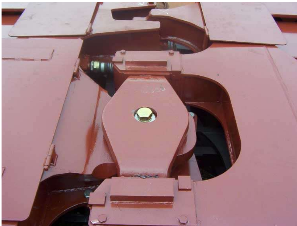
Obr. 13 Spojení obou částí rámu šestinápravového kontejnerového vozu se společným podvozkem typu Y25. [17]
