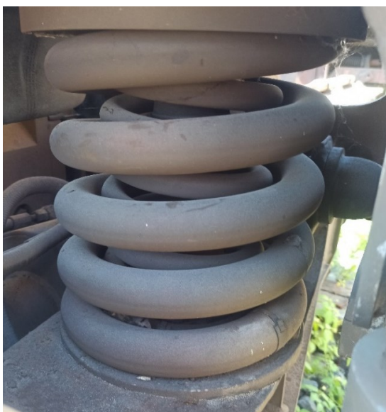
Obr. 9 – Sekundární vypružení hnacího podvozku; vpravo příčná nárazka
