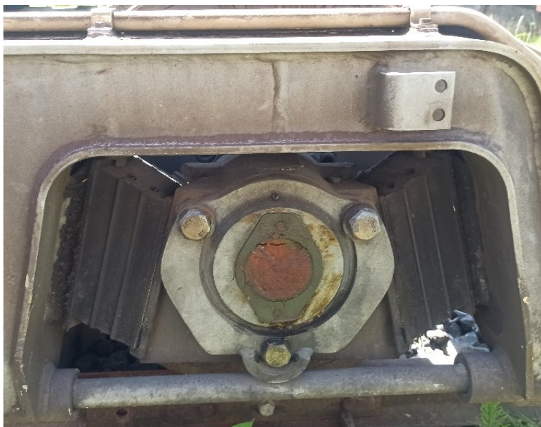
Obr. 5 – Primární vypružení hnacího podvozku
