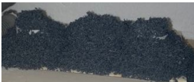
Obr. 36 Kalcinace EGTi s únikem vzorků mimo korundové kelímky.
