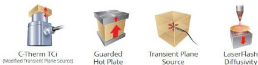
Obr. 18 Experimentální techniky pro měření tepelné vodivosti [18]
