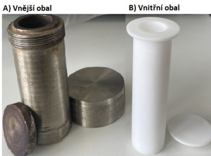
Obr. 29 Nádoby pro měření při hydrotermální syntéze
