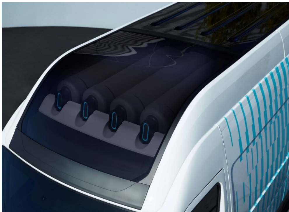
Obrázek 23 – Integrované vodíkové nádrže ve střeše automobilu
