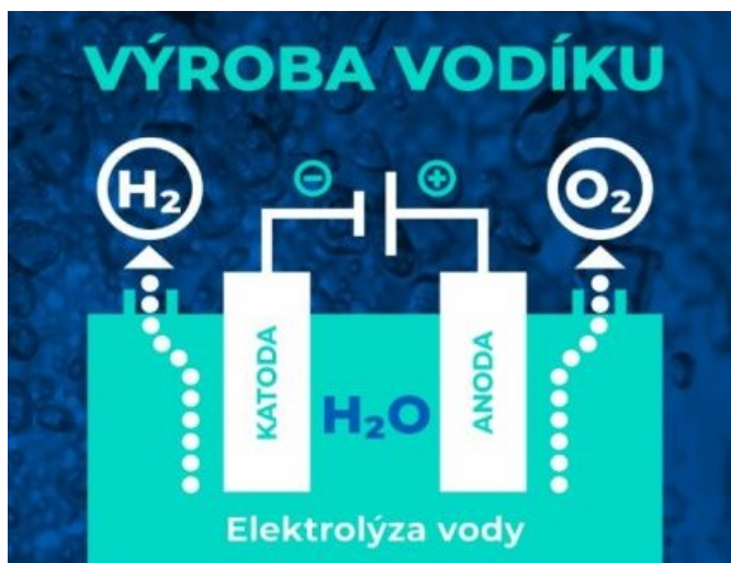
Obrázek 21 – Schéma výroby vodíku elektrolýzou vody
