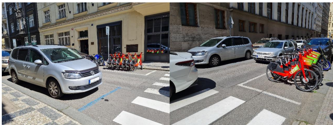
Obrázek 11 Viditelnost přijíždějících vozidel s vozidlem zaparkovaným na posledním parkovacím místě a bez něj
