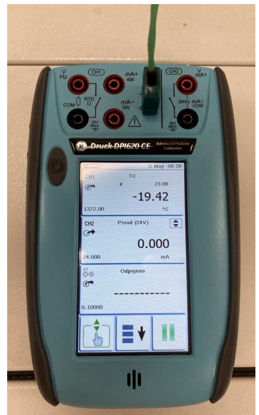
(b) Multifunkční kalibrátor se zapojeným termočlánkem
