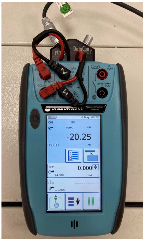
(a) Multifunkční kalibrátor se zapojeným odporovým čidlem Pt100
