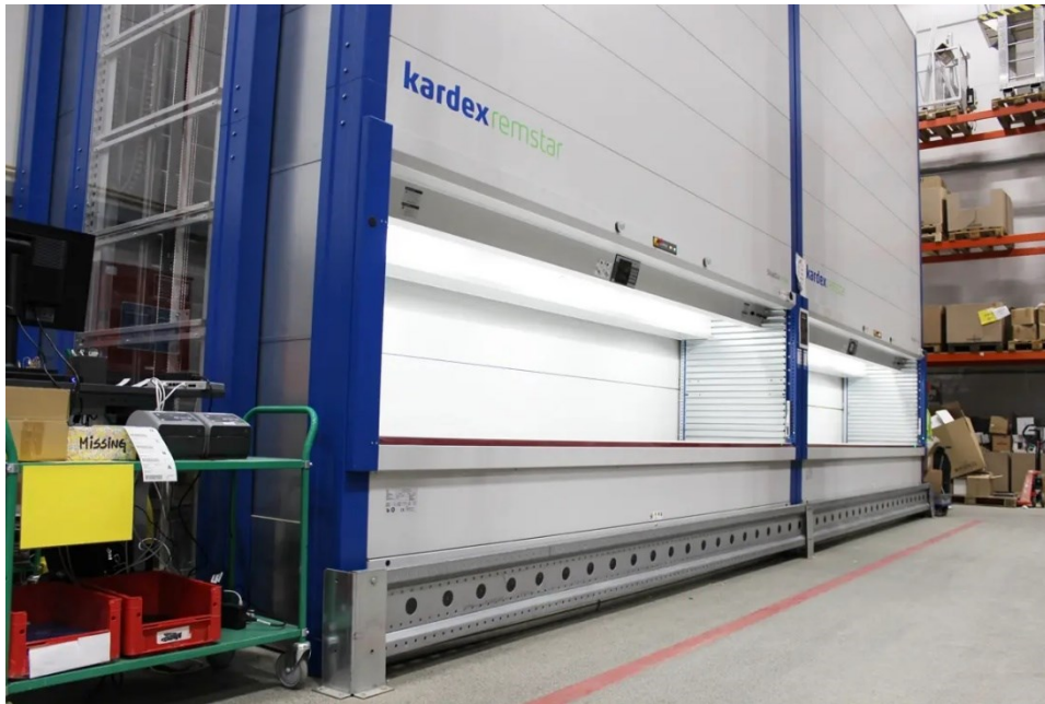
Obrázek 10 Typový příklad karuselového zakladače (Relevator, 2023)
