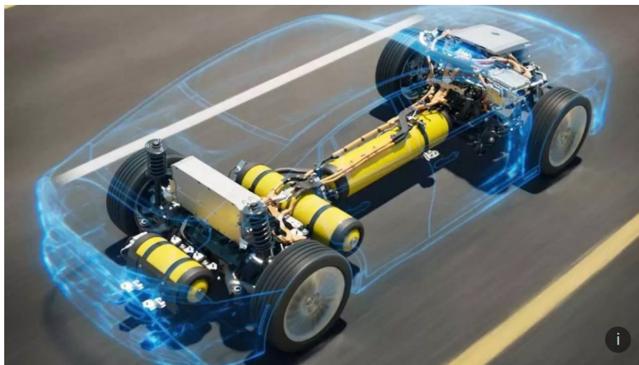
Obrázek 10 Uspořádání vodíkového pohonného ústrojí Toyota Mirai (InsideEVs, 2021)
