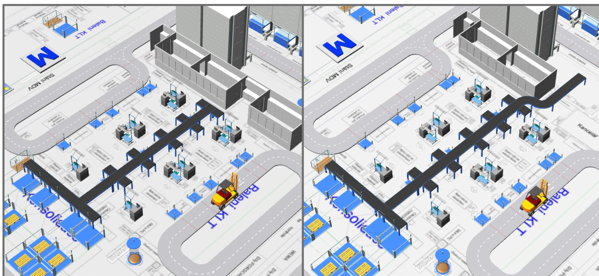
Obrázek 14 Současný a navrhovaný stav využití válečkového dopravníku na KLT lince (autor)
