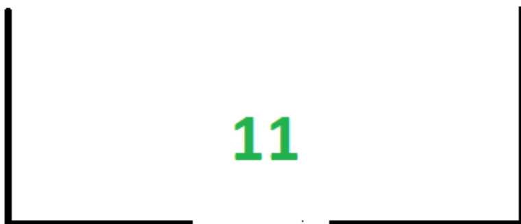
Obrázek 17 Označení skladové pozice na podlaze (autor)
