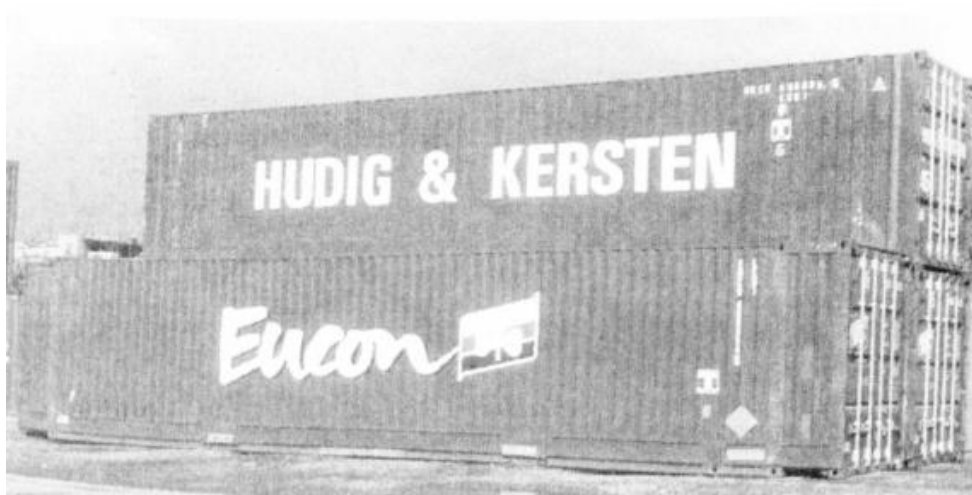
Obrázek 4 Kontejnery ISO řady 1 E (Novák a kol., 2015, s. 108)
