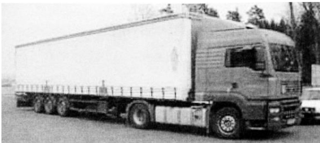
Obrázek 6 Jízdní souprava s plachtovou výměnnou nástavbou (Novák a kol., 2015, s 137)
