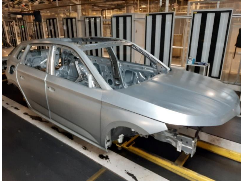
Obrázek 2.4 Hotová karoserie po pracovišti Finiš 2
