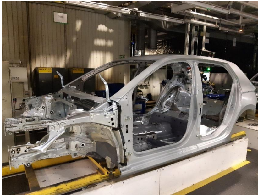
Obrázek 2.3 Stav karoserie po pracovišti Svařená 3
