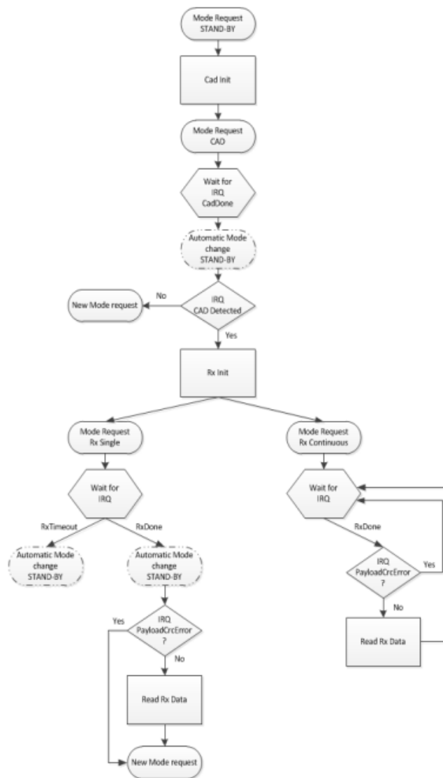
Obrázek 18 Modifikace diagramu pro příjem dat s využitím CAD [14]
