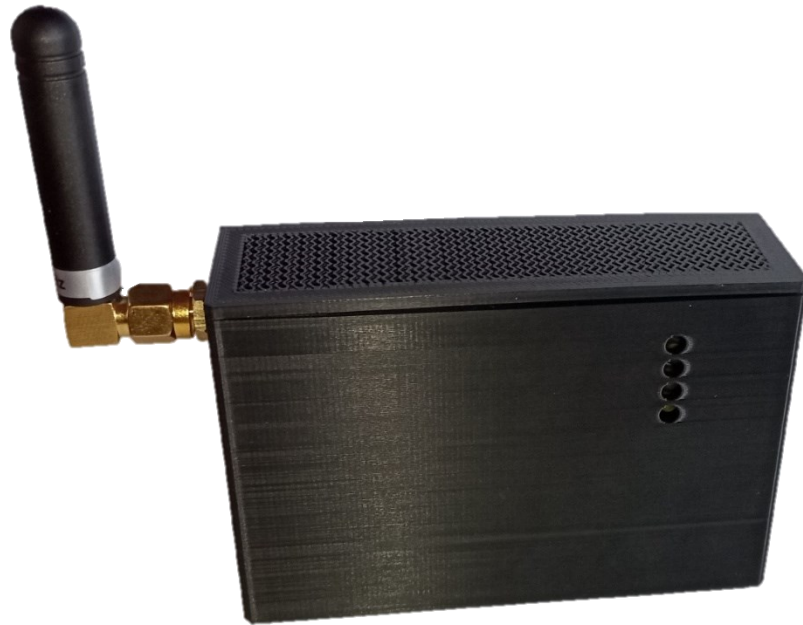
Obrázek 38 3D vytištěný model ochranného krytu IoT brány
