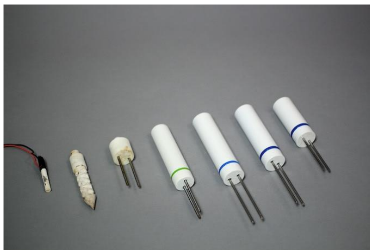
Obrázek 10 - Postupný vývoj zahradních senzorů PlantLink [24]
