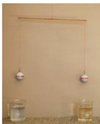
Obr. 52 Pokusy s rovnoramennými vahami – vztlaková síla 35
