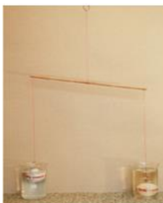
Obr. 52 Pokusy s rovnoramennými vahami – vztlaková síla 35
