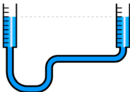
Obr. 26 Sada obrázků k hadicové vodováze 24, 7
