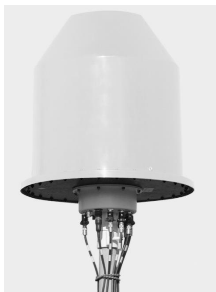
Obr. 7 – Pasivní radarový systém společnosti PLATH; vlevo: přijímač DFP 2410, vpravo: anténní jednotka CMA 2400 (zdroj: [4], [5])
