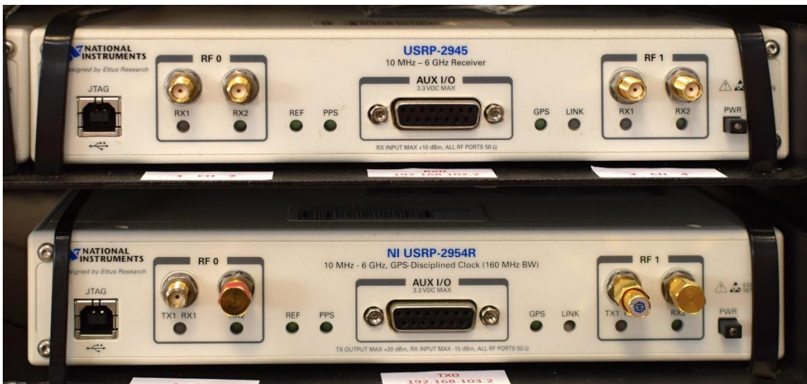
Obr. 45 – Detail SDR modulů (nahore: SDR modul USRP-2945 využit jako přijímací, dole: SDR modul USRP-2954R využit jako vysílací)
