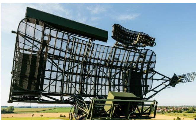
Obr. 6 – Pasivní systém PLESS založený na směroměrného principu zjišťování zdroje signálů; vlevo: anténní jednotka systému PLESS, vpravo: princip fungování systému PLESS (zdroj: ERA, a.s. [8])
