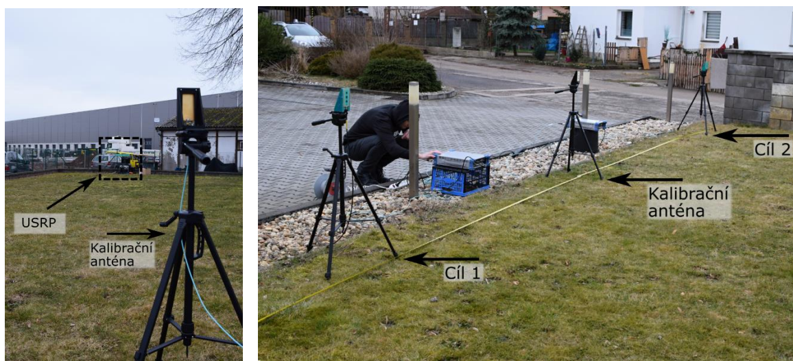
Obr. 63 – Fotografie vysílací strany; vlevo: pohled od kalibrační antény směrem k přijímací straně, vpravo: rozmístění vysílacích antén reprezentující cíle a kalibrační antény
