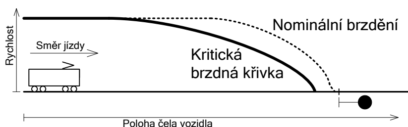
Obrázek 17 Srovnání nominálního a kritického brzdění
