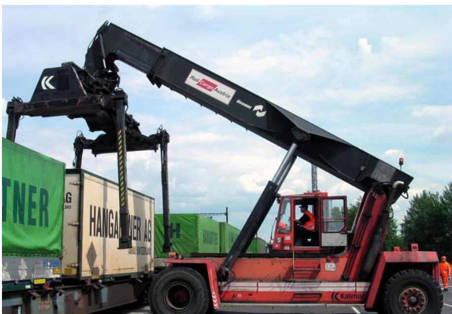
Obrázek 3 Překládka s využitím spreaderu (K-report, 2021)
