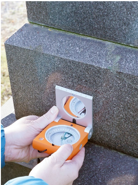
Obr. 31 a–d: Ukázka měření náklonu náhrobní stély pomocí kompasu s inklinometrem a s pomocí geologického kompasu typu Freiberg (vlevo dole). V případě měření pomocí kompasu je zapotřebí změřit zvlášť náklon náhrobku (vpravo nahoře) a zvlášť azimut tohoto náklonu (vpravo dole). Při měření geologickým kompasem lze obě hodnoty odečíst naráz. Náhrobek kamenického mistra Ernesta Fischera na starém hřbitově ve Skorošicích.
