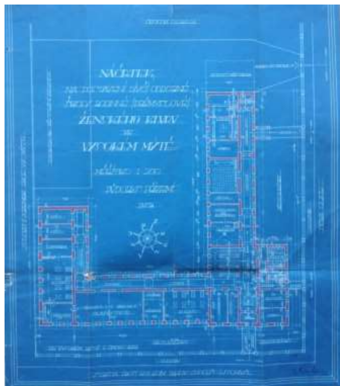
Obrázek 191. Náčrt na postavení dívčí odborné školy rodinné /průmyslové/ ženského klubu ve Vysokém Mýtě, půdorys přízemí (Archiv stavebního úřadu ve Vysokém Mýtě, Základní škola Jiráskova, fotografie autorka)
