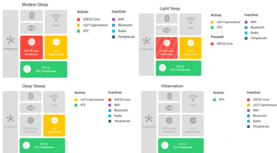
Obrázek 8 Úsporné režimy ESP32 [22]
