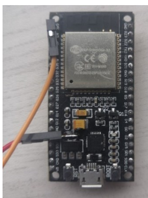
Obrázek 16 ESP32 na kterém probíhalo měření
