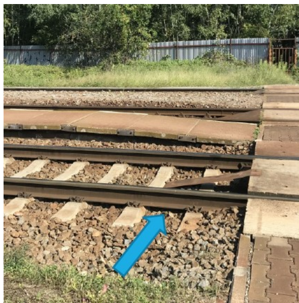
Figure 3.22 – Hradec Králové Locality – Position of a Thermometer in Slezské předměstí District (Thermometer from the bottom of the Rail Foot), Author Dr. Vladimír Suchánek
