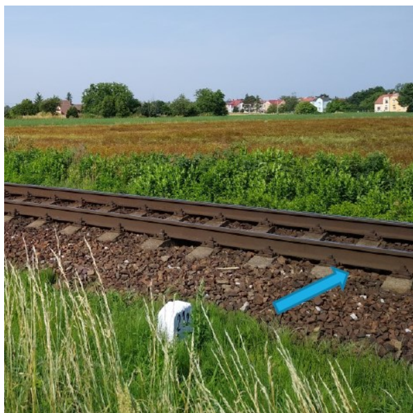
Figure 3.21 – Hradec Králové Locality – Position of a Thermometer in Pražské předměstí District (Thermometer from the bottom of the Rail Foot), Author Dr. Vladimír Suchánek
